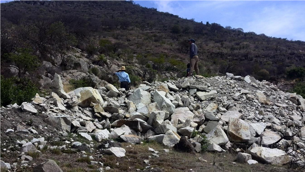
Piedra braza (cantera) la utilizan solo para la cimentación y en obras de beneficio social del municipio
