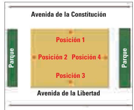
Figura 1. Croquis de la parcela con la posición de los puntos de reconocimiento geotécnico.
