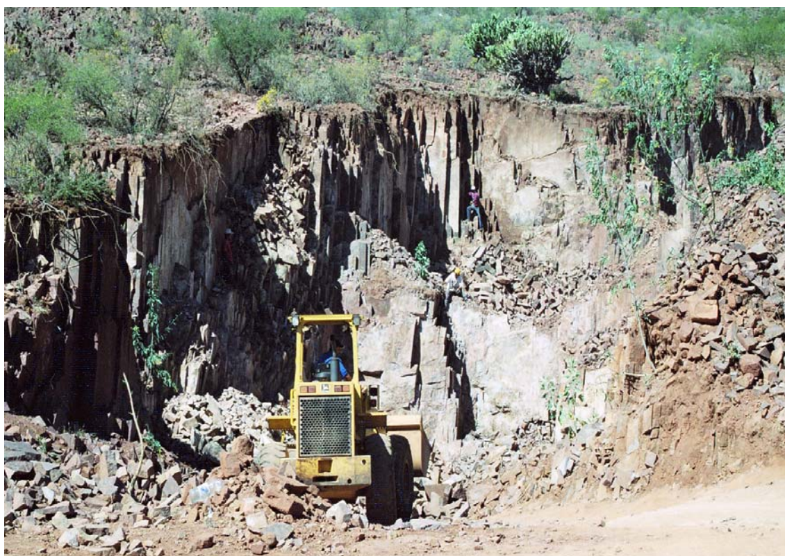
Fotografía 15. Área de explotación al oriente del cerro Los Charcos, del Grupo Empresarial de Laja Los Charcos, con espesor de laja de 12 a 20 cm.
