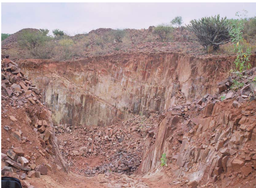
Fotografía 11.- La riolita porfídica presenta un fuerte diaclasamiento con separación de 3 a 10 cm. cortado por fracturas que están inclinadas a la derecha.
