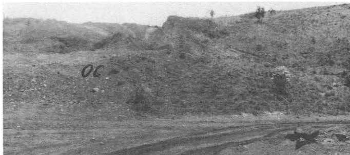
Fig. 12. Depósitos de ocre de la región de El Tigre Edo. Cojedes bajo minería intensiva. La mena está constituida esencialmente por una mezcla íntima de óxidos e hidróxidos de hierro originada a partir de procesos complejos de meteorización, regolitización y transporte afectando niveles superiores de serpentinas. OC. Ocre.
