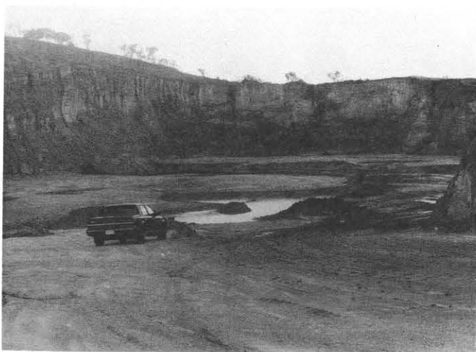
Fig. 21. Minería a cielo abierto sobre secuencias ricas en cuarzo aluvional de alta calidad. Zona de Taguanes, Estado Cojedes. El Estado Cojedes es el mayor productor de cuarzo del centro del país. El material es consumido por las industrias de la construcción, revestimiento, siderurgia y abrasivos.
