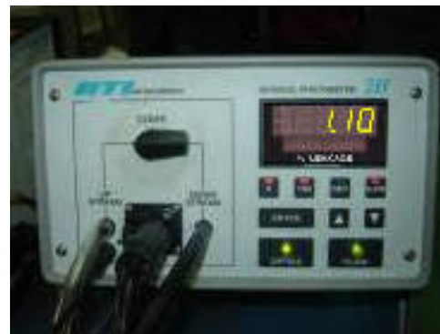
Fig. 5. Resultado incorrecto: fuga Wrong result: filter leaking
