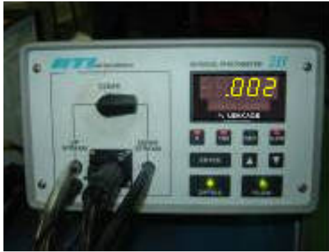
Fig. 4. Résultat correct : aucune fuite Korrektes Ergebnis: kein Leakage
