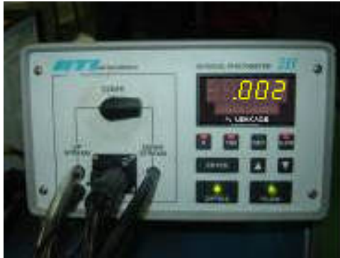
Fig. 4. Resultado correcto: no fuga Correct result: filter not leaking
