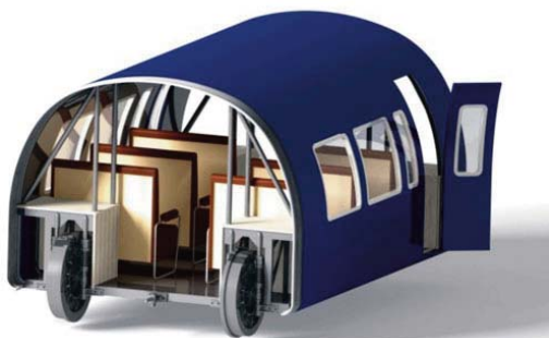
Fig. 26. (a) Vagón 12 plazas delantero. Capacidad para 12 pasajeros. 3D; (b) Vagón 12 plazas trasero. Capacidad para 12 pasajeros. 3D
