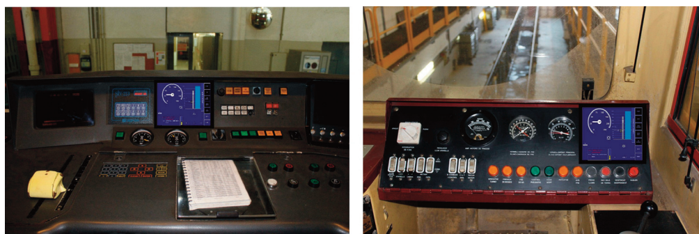
Fig. 8. Situación del DMI en (izquierda) Unidad 213 de FGC y (derecha) en Locomotora Diesel de FGC
