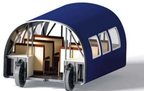
Fig. 26. (a) Vagón 12 plazas delantero. Capacidad para 12 pasajeros. 3D; (b) Vagón 12 plazas trasero. Capacidad para 12 pasajeros. 3D
