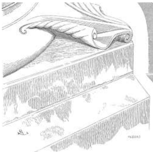
Base de colonne avec abattu de l'église de Poissy. Viollet-le-Duc, Dictionnaire raisonné .
