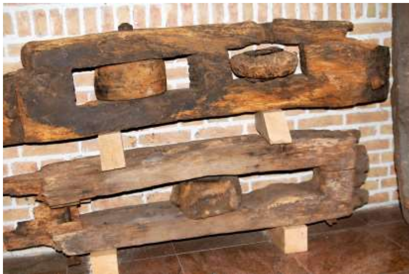
Galets de centrage provenant du moulin-tour à pivot central de Templeuve. CRM. Photo de l'auteur.
