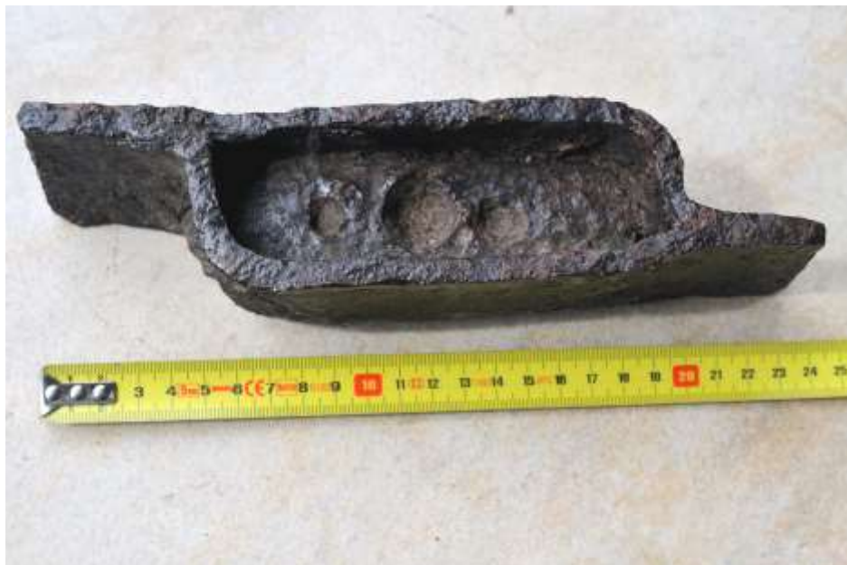
Crapaudine du 18 e s. avec son coussinet central, un creux et un véritable noyau dans ce creux. CRM Photo de l'auteur
