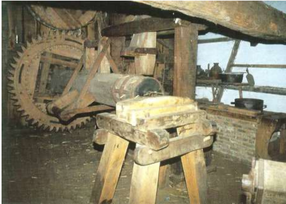
Estalage portant l'arbre à cames du moulin à huile hydraulique d'Ellikom (Limbourg) déplacé au musée en plein air de Bokrijk. Photo P.B.
