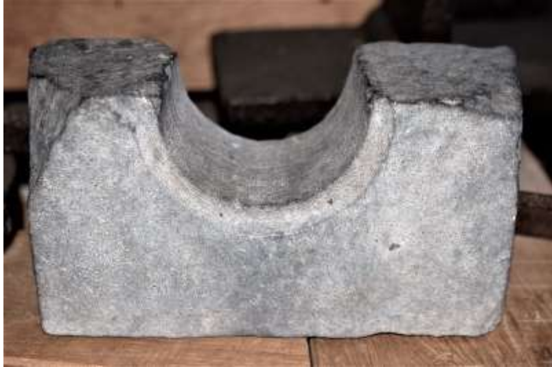
Marbreau en pierre d'un moulin à eau. CRM. Photo de l'auteur.
