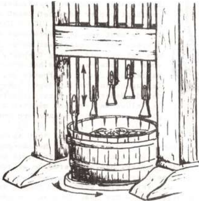
Bac-hachoir, p. ex. d'un moulin à garance. Dessin G. Kockelberg
