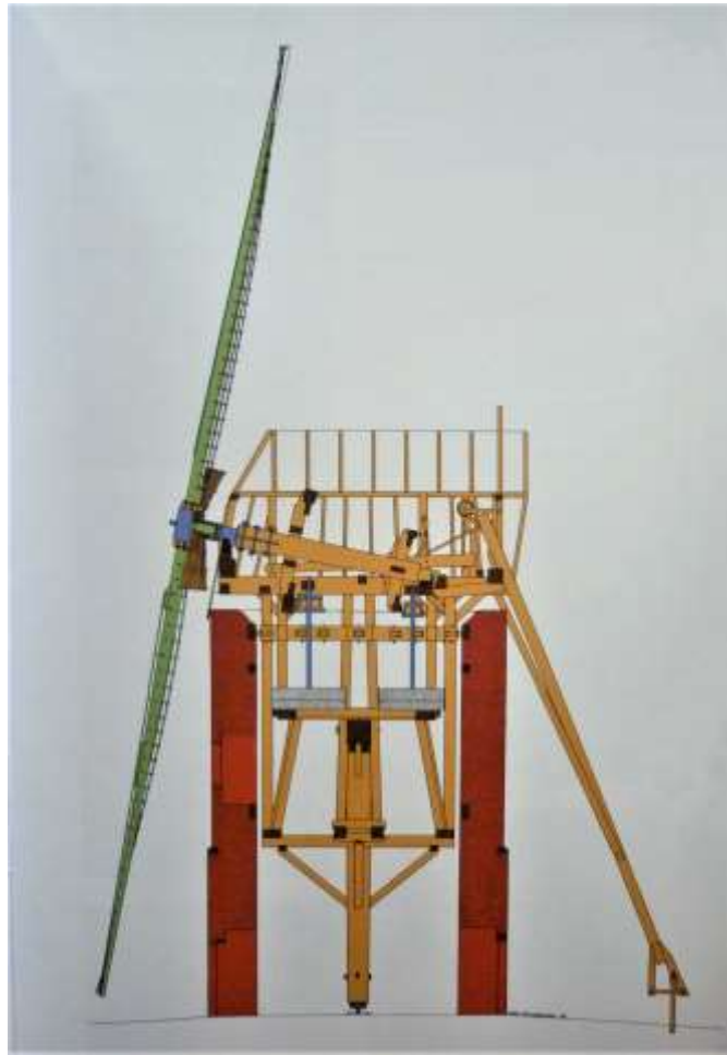
Corps du moulin de Templeuve porté par le pivot tournant ( pioche ) et indépendant de la tour maçonnée. Dessin J.B.
