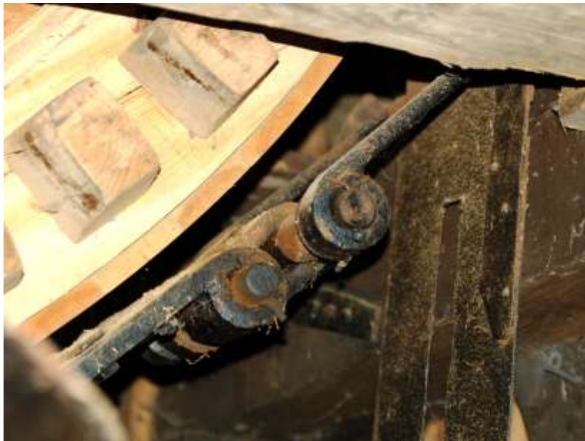
Deux formes d'œils servant à la fixation de la ceinture du frein, en haut Gistel (Fl.-Occ.), en bas Huise (Fl.-Occ.)
