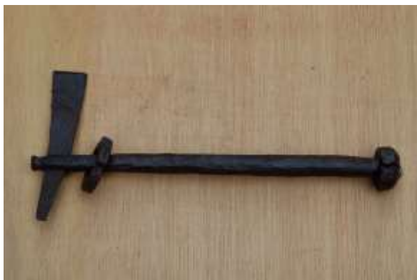
Cheville d'assemblage avec la rondelle (flotte) et la clavette (clef). CRM 974-3-33-1. Photo de l'auteur en collaboration avec J.B.
