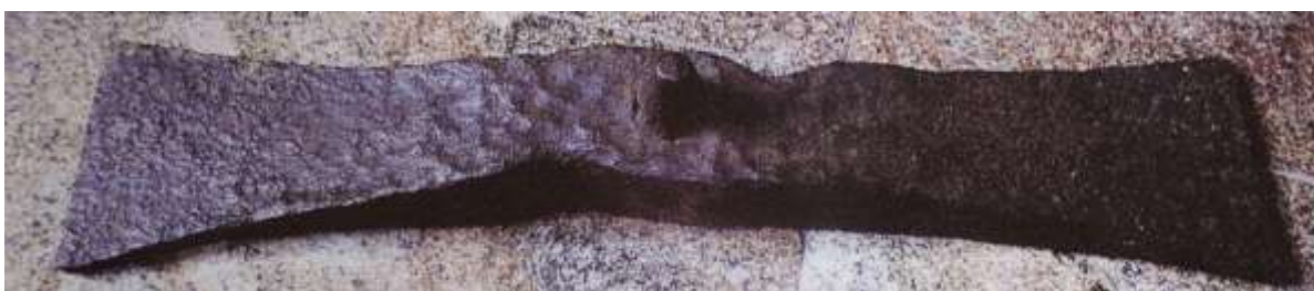
Anille en forme de doloire du moulin de Saint-Pierre-le-Moûtier (Nièvre). Photo J.B.
