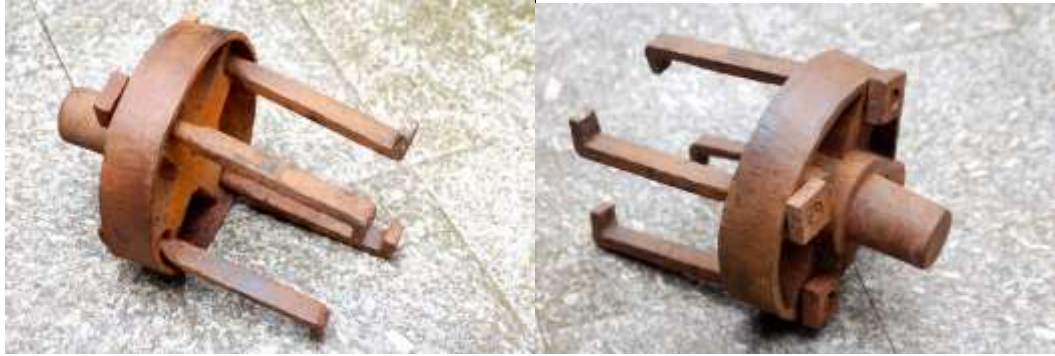
Tourillon d'un arbre de moulin à eau, qui peut être fixé par quatre martinets entourés d'un cercle de fer. Ici les martinets sont déjà tenus en place par une croix de fer à l'intérieur du cercle. CRM. Photos J.B.
