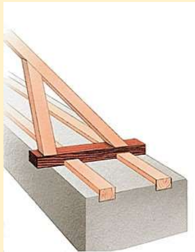
Blochets portant l'arbalétrier et une jambette de consolidation.
