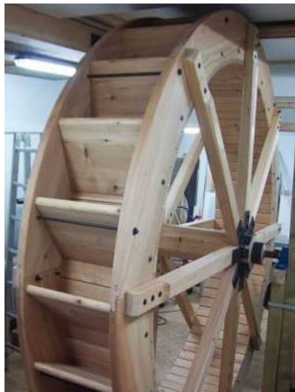
Roue à coiseaux et à plats cernes dans son atelier de fabrication.
