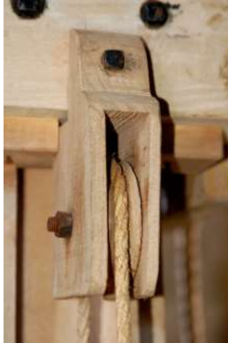
Moulin à huile de l'Oostmolen à Gistel (Fl.-Occ.) : moufle fixée au moufler et servant à la corde au moyen de laquelle le tordeur soulève la °hie. Photo de l'auteur.
