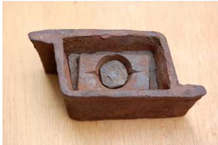
Crapaudine du 18 e s. avec son coussinet central, un creux et un véritable noyau dans ce creux. CRM Photo de l'auteur
