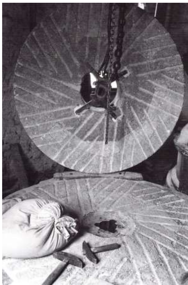
Emploi de la queue . La meule courante est redressée sur la queue , dont les deux chevilles sont encore visibles. Ruiselede (Fl.-Occ.) 1977. Photo J.B.
