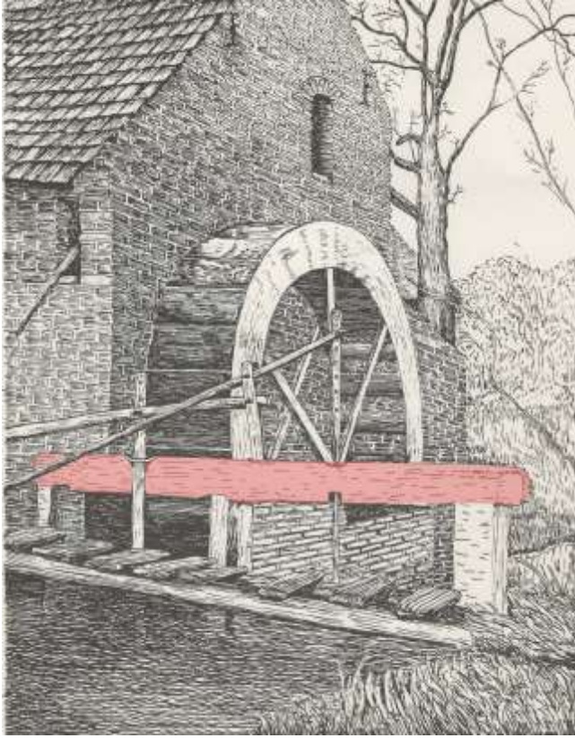
Teliere du Leverenmolen à Neeroeteren (Limbourg). Dessin H.C.
