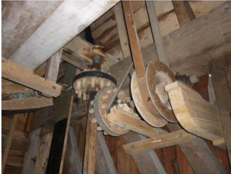
Careulles ou petits rouets pour l’agitateur du moulin des Olieux à Villeneuve-d’Ascq. Photo de l’auteur.
