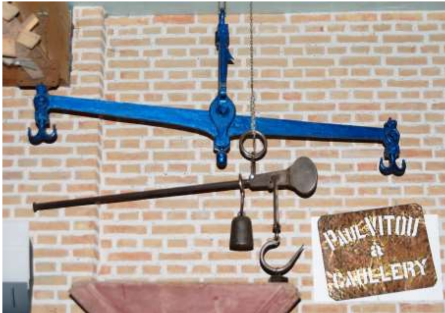
En haut, balance à fléau ; en bas balance romaine. CRM. Photo de l'auteur.
