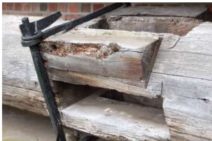
Ailette fixée au moyen d'une °bende croisee à la tête d'un arbre moteur de moulin à vent. C.R.M. Photo de l'auteur.
