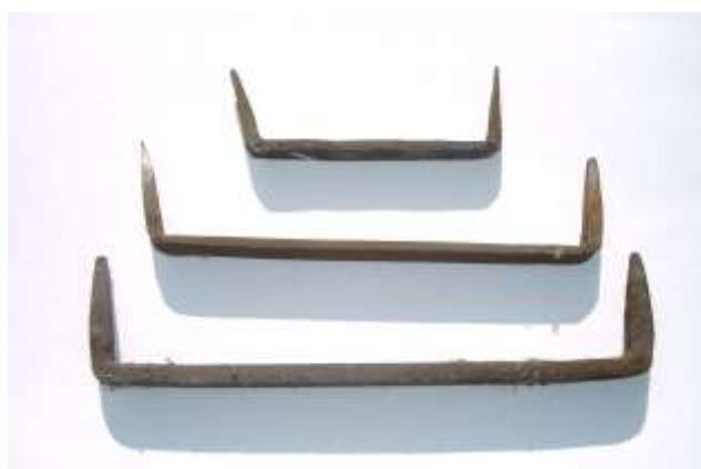
Agrafes (clameaux) de charpentier. Photo StromBer. Wikipedia allemand
