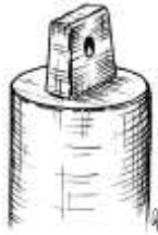
Téton au-dessus de la fusée d'un petit fer de meule. Dessin G.P.
