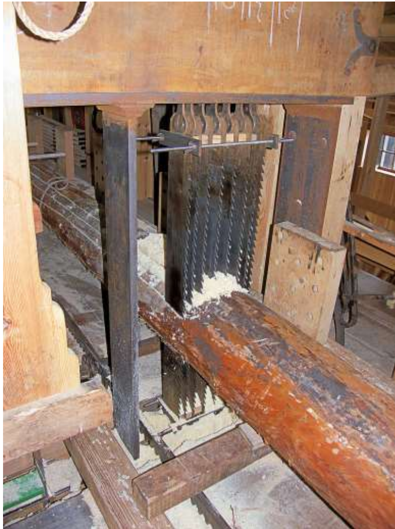
Zaandam (Pays-Bas), Moulin à scier Het jonge schaap . Châssis des scies. Rasbak, CC BY-SA 3.0 < https://creativecommons.org/licenses/by-sa/3.0 >, via Wikimedia C
