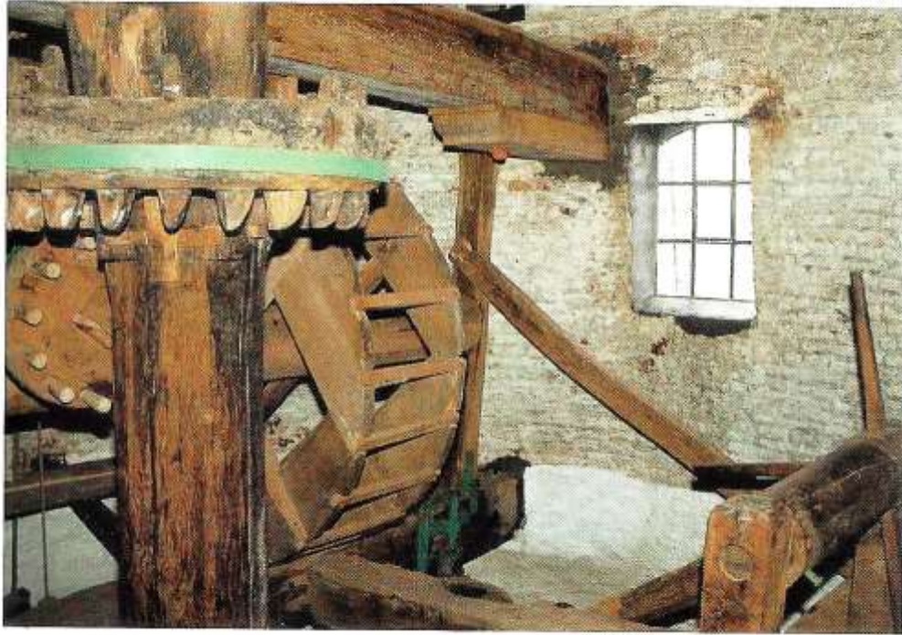
Moulin à vent en pierre de Herzele (Fl.-Or.). Tambour du treuil aux meules avec son petit touret muni de bras de levier. Photo P.B.
