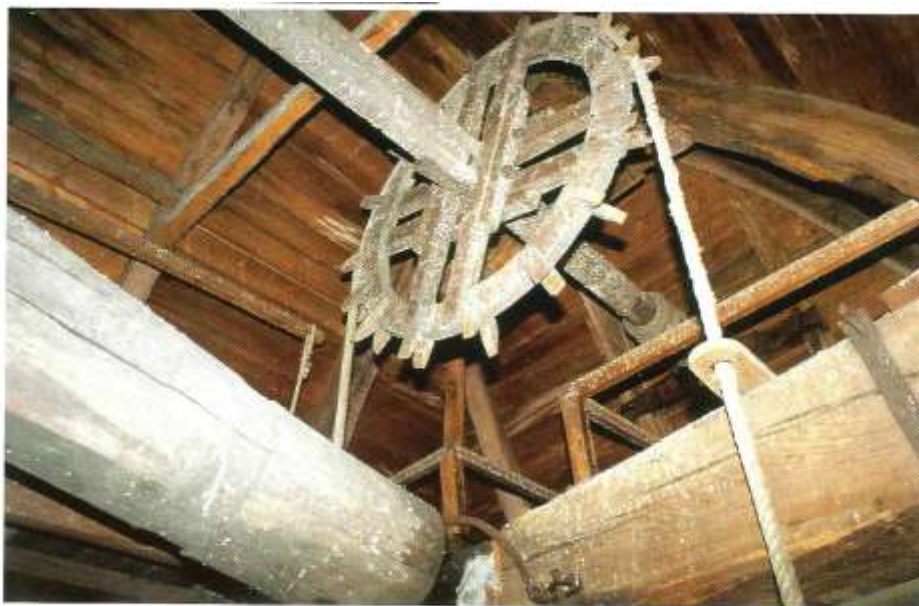
Roue à fourches en bois du moulin de Bokrijk (Limbourg)
