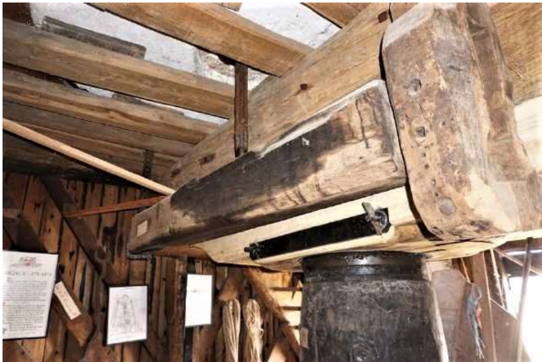
Pont du moulin de Rullegem à Herzele (Fl.-Or.). Notez au centre le petit fer de meule et à l'extrémité gauche du pont l'épée de la temprure. Photo A. Goublomme.
