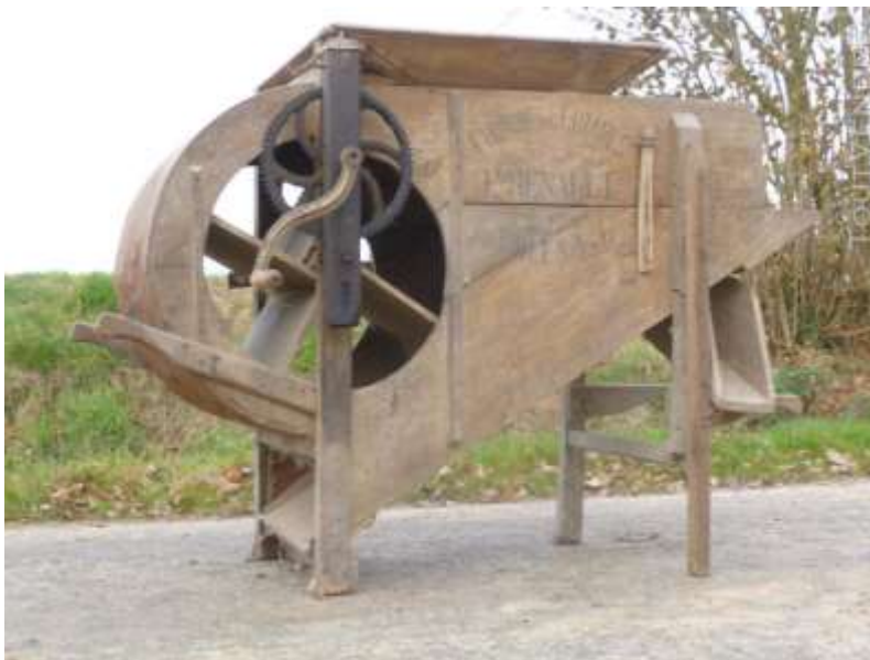
Diable volant, tarare à ventilateur.
