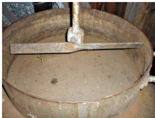
Lame de l'agitateur du moulin à huile de Villeneuve-d'Ascq. Photo de l'auteur.
