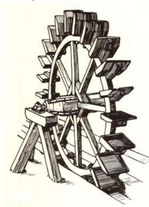
Roue du moulin de Chantilly à bras et enrayures. Dessin J. Orsatelli.
