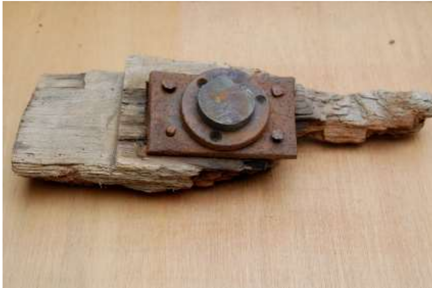
Hurtoir , butée de l'arbre moteur en bronze fixée sur un tronçon du palier de hurtoir du moulin d'Oye-Plage (Pas-de-Calais). CRM 002-04-02. Photo de l'auteur.
