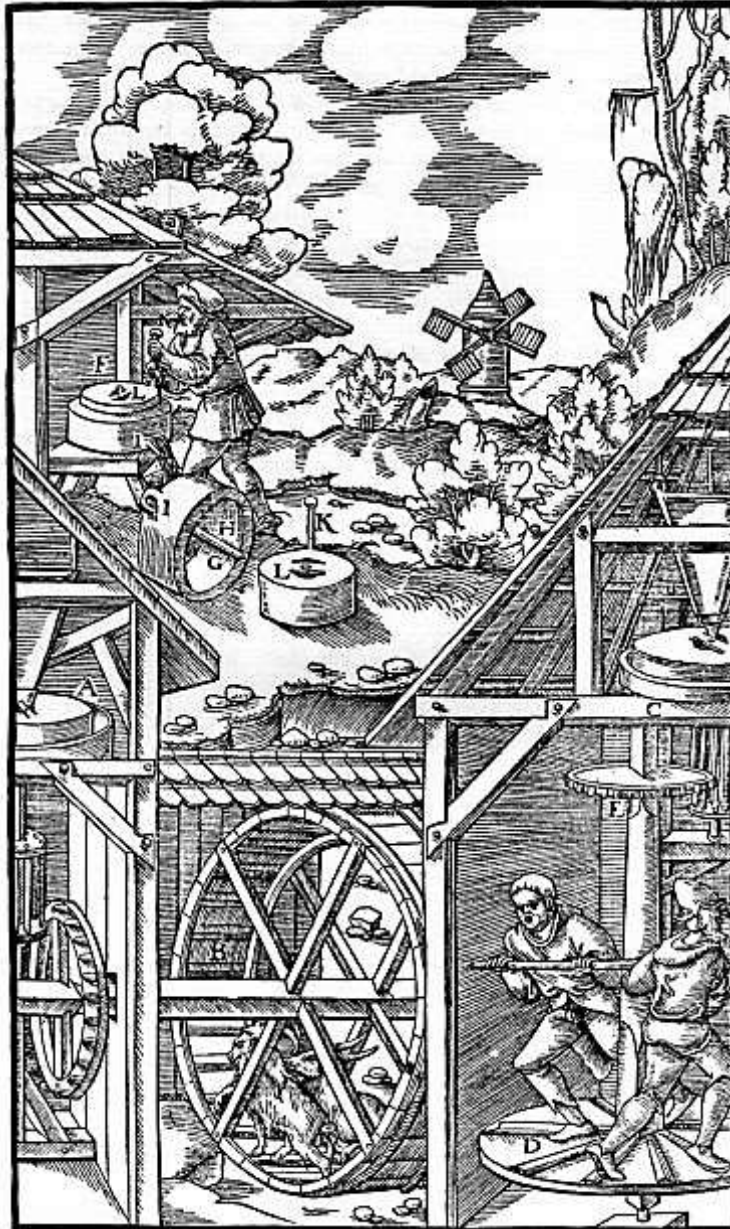
AGRICOLA, De re metallica : moulin à cage d'écureuil (à chèvres !) et à trottoir tournant.
