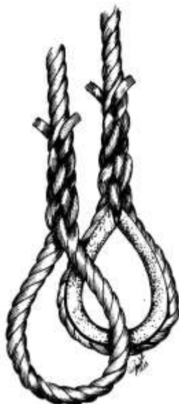
Boucle d'un câble sans doublure et avec une doublure de cuir. Dessin G.P.
