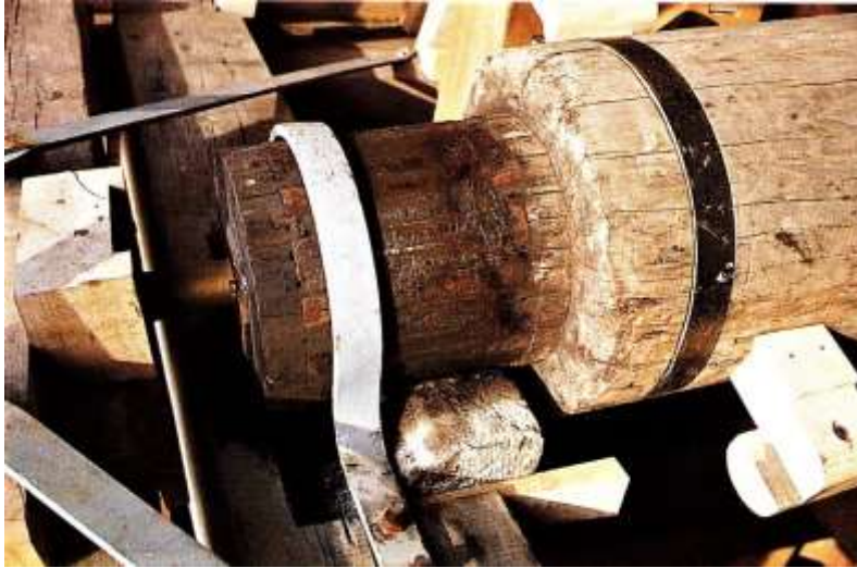
Petit bout de l'arbre moteur du moulin des Olieux à Villeneuve-d'Ascq. Le petit collet aux alumelles est maintenu sur son marbre au moyen d'une barre de fer courbée. À l'extrémité de l'arbre il y a un tourillon qui bute contre un bloc. Photo J.B. (1985).
