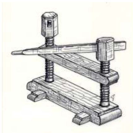
Vérin du charpentier de moulin. Dessin G.P.
