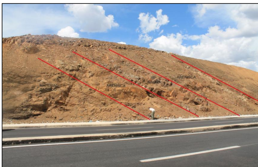
Figura. 3.20 Formación Guaiquera. Parada Gu-14-06. Afloramiento de alternancia de arenisca, caliza y material caótico en la Av. Fuerzas Armadas.
