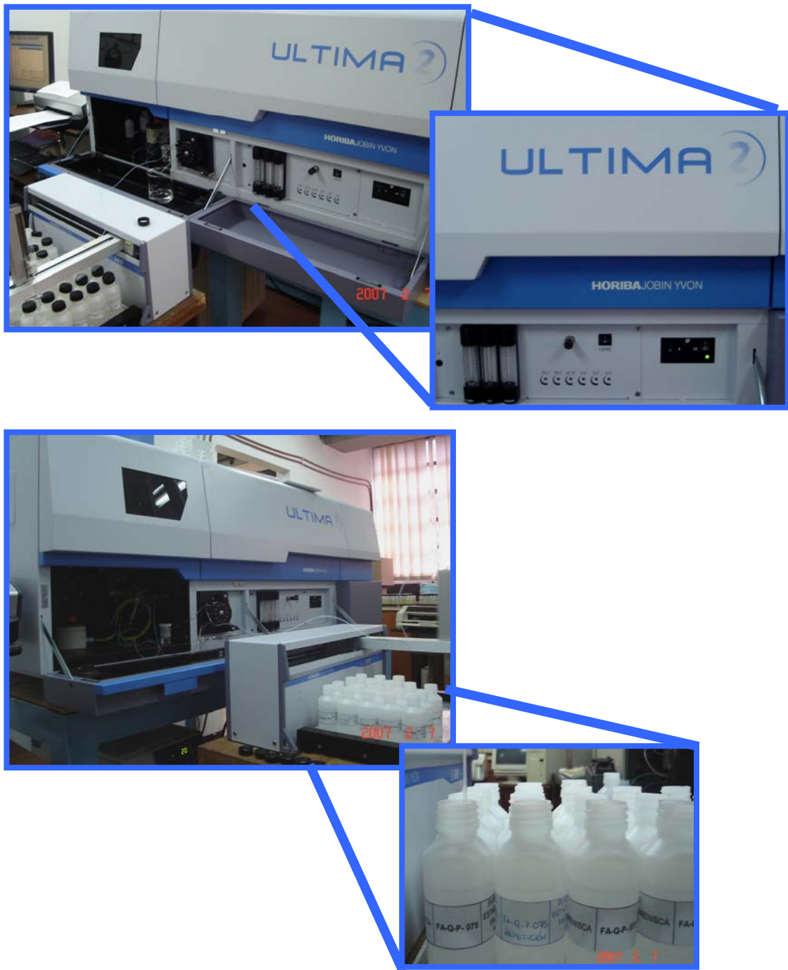
Figura 17: Espectrómetro de emisión óptica con plasma inductivamente acoplado (EEO-IAP), modelo ULTIMA 2 marca HORIBA Jobin Yvon.
