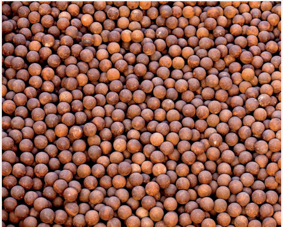
Las bolas de molino se utilizan para la trituración del mineral en la Planta Concentradora.
