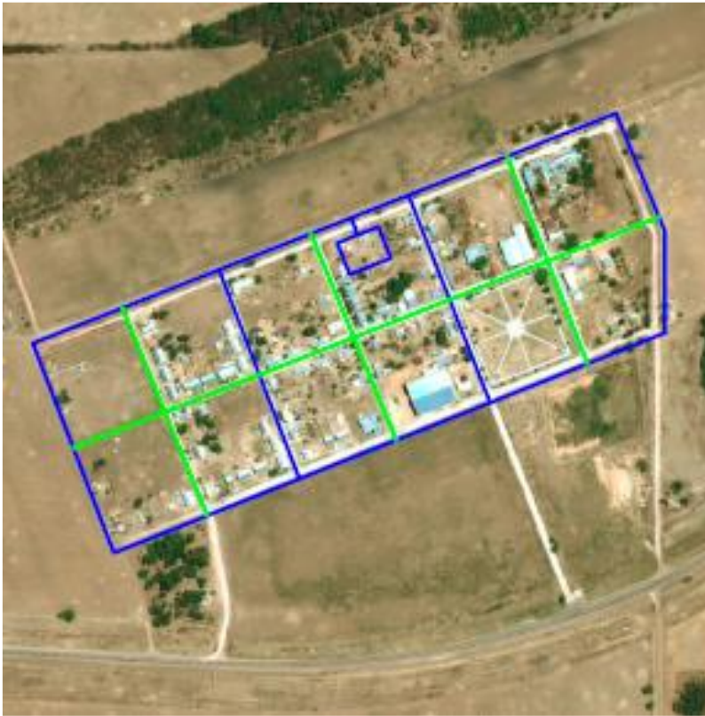
Figura 3: Capdevilla: Red de distribución de agua proyectada
