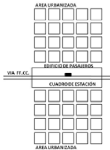
Figura 60: Croquis de ubicación estación ferroviaria
