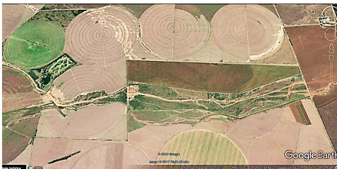
IMÁGENES 6 a 9 Secuencia detallada de la situación al 2016 de manejos inadecuados. Primer tramo profundización y carcavamiento; construcción de pívot en sectores de transito y canalización irregular de aproximadamente 3km por medio de lo que era una línea de pívot hoy inutilizados
