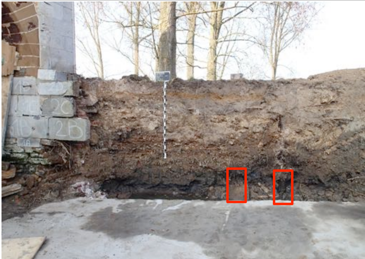
Fig. 4.8: Bodemopbouw (Pr1) achter de noordelijke muur met aanduiding van de houten balk.
