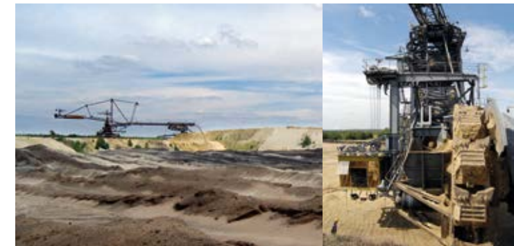
Absetzer beim Auffüllen von Tieflagen im Sanierungsgebiet Nochten, 2004
