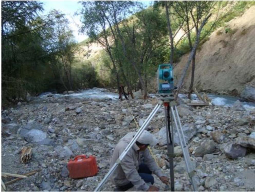
Imagen II. 29 Vista del cauce del rio para la consideración de los coeficientes de rugosidad en el cauce.
