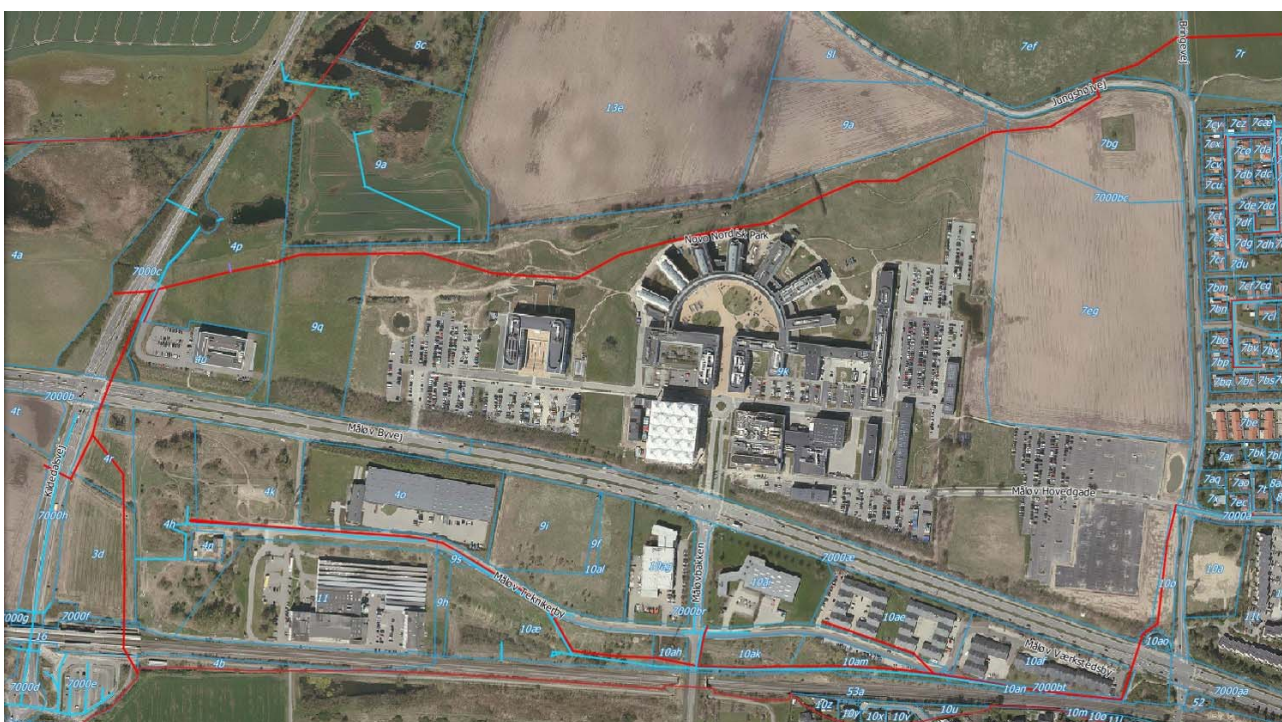
Større spildevandsledninger (rød) og regnvandsledninger (lysblå)
