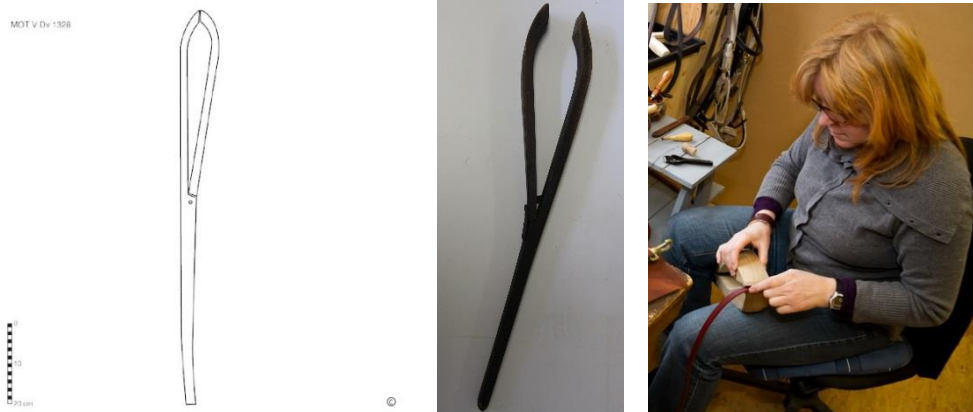
Figuur 75: Een naaispan, werktuig van de gareelmaker, ongedateerd. Collectie MOT en Museum van het Belgisch trekpaard.
