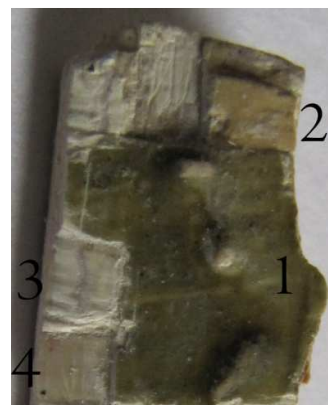
fig. 135: Verschillende verflagen op een zuil, eigen foto april 2010
