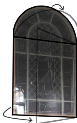
fig. 253: Principetekening voorzetbeglazing bij het onderhoud
