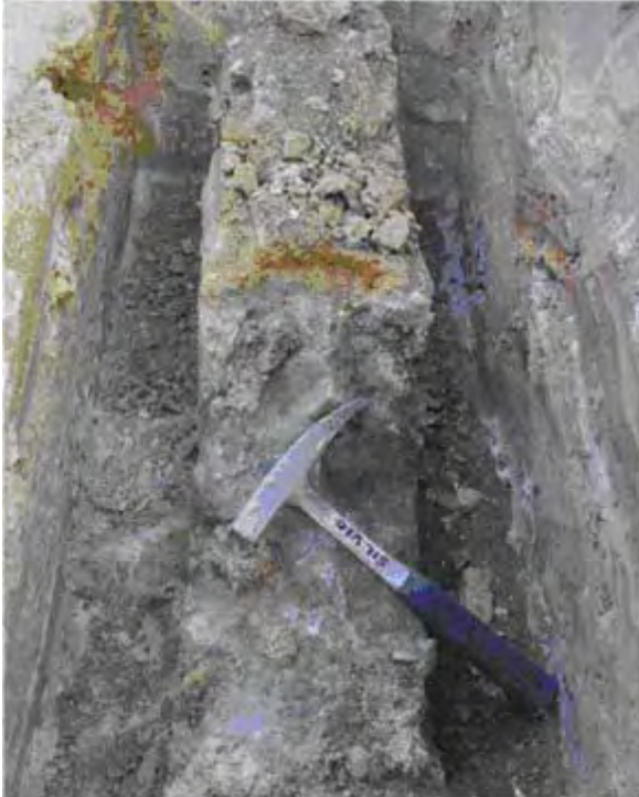
Suelo congelado muestra saturación de hielo. Fuente. BGC (estudio Casale, p.41)
