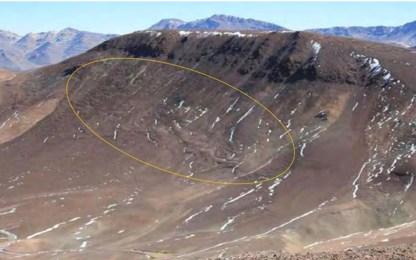
Ladera con “gelifluxión” reconocida por pequeñas cimas y surcos, indica probable presencia de suelos congelados. Fuente BGC/Casales p.55
