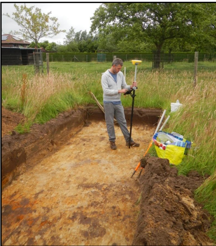
Figuur 20: Opmetingen van de sleuven, grondsporen en hoogtes met een GPS toestel.
