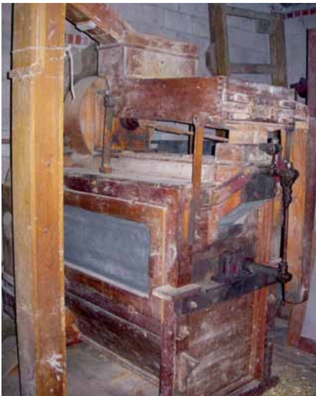
FIG. 46 Samengestelde sorteercilinder of trieur van de firma Louis Bonte (Leuven) in de Knokmolen in Ruislede. Cylindre de tri ou trieur monté de la société Louis Bonte (Leuven) dans le Knokmolen à Ruislede. Compound grader by Louis Bonte (Leuven) at the Knok Mill, Ruislede.
