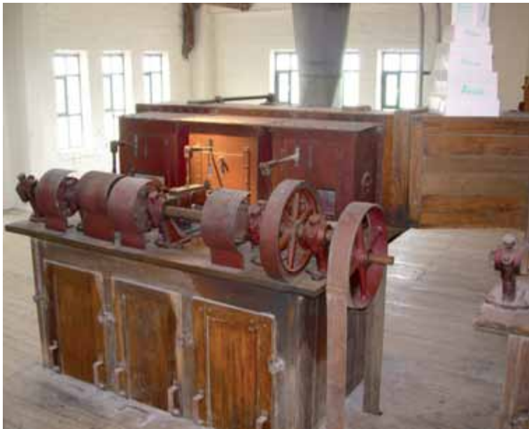
FIG. 102 Stofafklopinstallatie van de firma Schneider, Jaquet & C ie in de Bloemmolens van Diksmuide.
