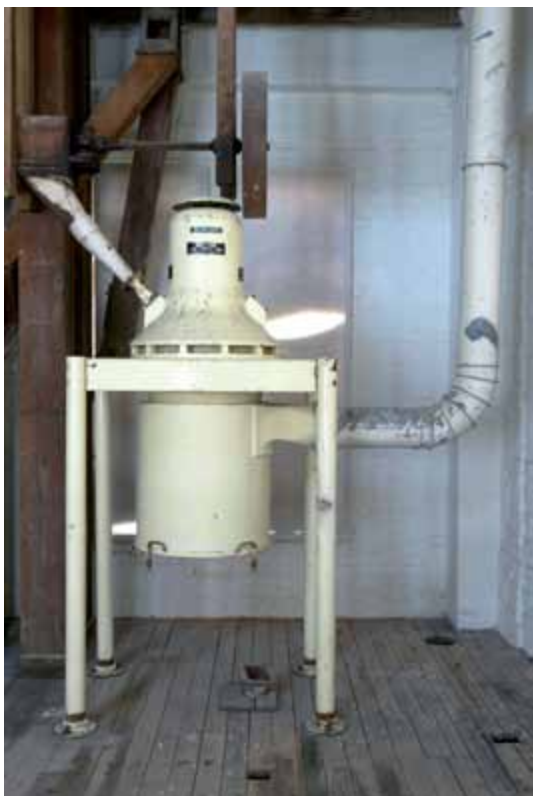
FIG. 144 Entoleter van de firma Henry Simon Ltd in de Bloemmolens van Diksmuide.
