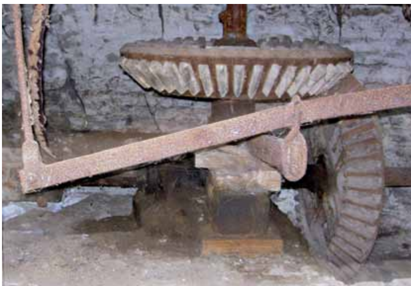
FIG. 41 Liggend drijfwerk in tot mechanische maalderij aangepaste Kruiskalsijdemolen in Leke (Collectie Clayhem Campagne, Keiem). Engrenage horizontal dans le Kruiskalsijdemolen à Leke transformé en meunerie mécanique.
