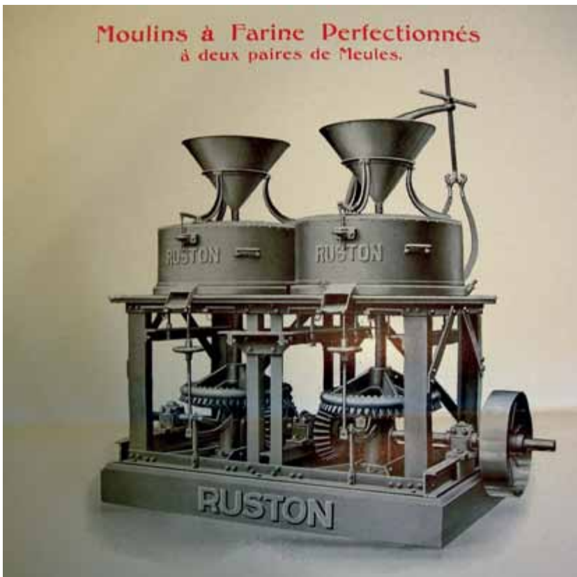
FIG. 48 IJzeren dubbele maalstoel van de firma Ruston, Proctor & C ie Ltd. (publiciteitsfolder) (Collectie Museum voor de Oudere Technieken, Grimbergen). Double chaise en acier de la société Ruston, Proctor & C ie Ltd. (dépliant publicitaire). Double iron millstone frame by Ruston, Proctor & C o . Ltd (advertising brochure).
