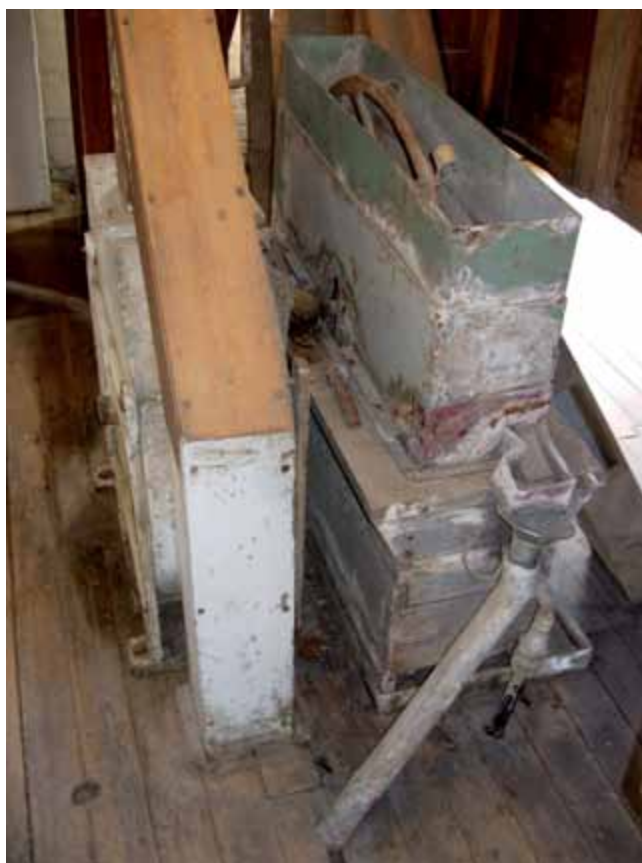
FIG. 124 Bevochtiger van de firma Schneider, Jaquet & C ie in de Bloemmolens van Diksmuide.
