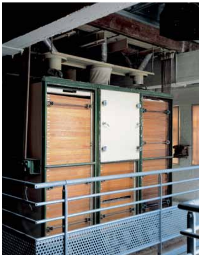
FIG. 142 Vierkante plansichter van de firma Henry Simon Ltd in de Bloemmolens van Diksmuide.
