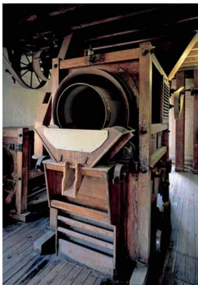
FIG. 112 Houten voorreiniger 'Mercure' van de firma Schneider, Jaquet & C ie in de Bloemmolens van Diksmuide. Préparateur en bois 'Mercure' de la société Schneider, Jaquet & C ie dans les Bloemmolens van Diksmuide . Wooden 'Mercure' pre-cleaner by Schneider, Jaquet & C ie at the Diksmuide Flour Mills.
