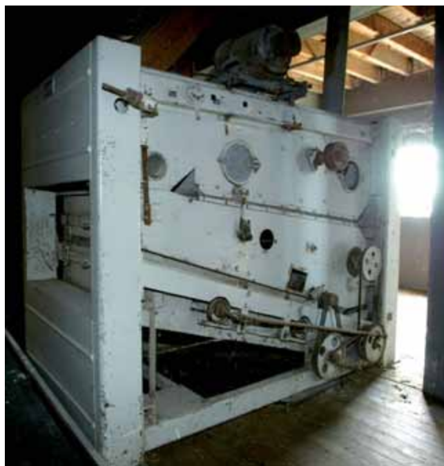
FIG. 110 Sorteertoestel ( trieur ) van de Maschinenfabrik Heid AG in de Bloemmolens van Diksmuide.
