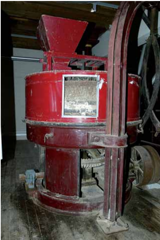
FIG. 254 Gietijzeren maaltstoel (met koppel maalstenen) van de firma LMS in de Bloemmolens van Diksmuide. Chaise en fer forgé (avec couple de meules) de la société LMS dans les Bloemmolens van Diksmuide. LMS cast-iron millstone frame (with pair of millstones) at the Diksmuide Flour Mills.
