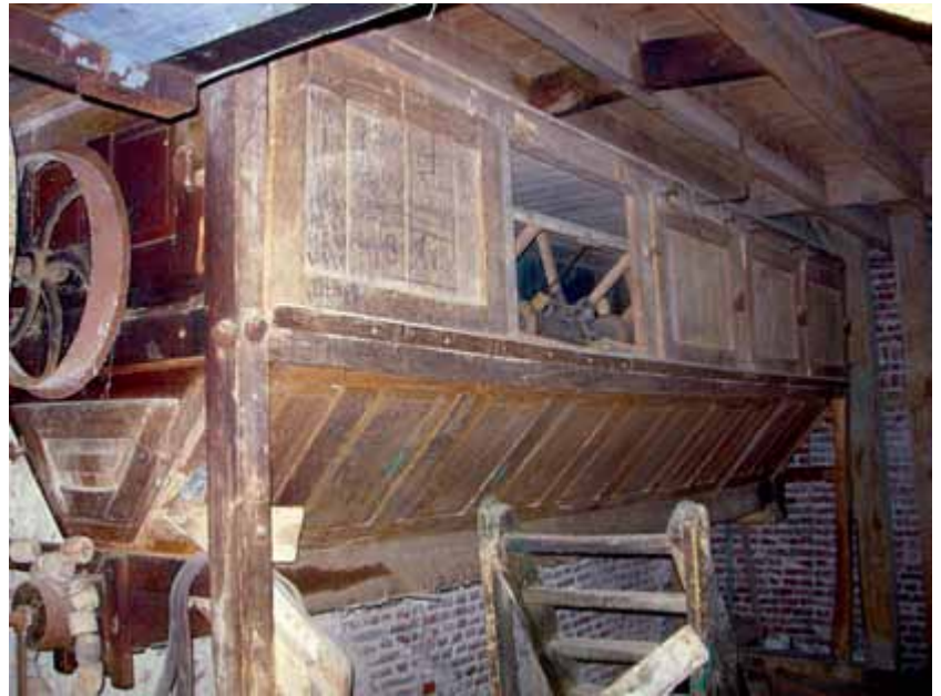
FIG. 57 Zeskantbuil in de maalterij Six in Reningelst (Collectie Clayhem Campagne). Bluteur à 6 tamis de la meunerie Six à Reningelst. Hexagonal bolter at the Six flour mill in Reningelst.
