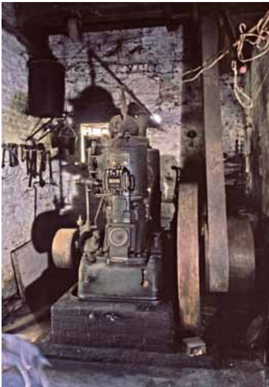
FIG. 211 Lister-dieselmotor in de Fonteintjesmolen in Meerbeek (Collectie R-O Vlaanderen, Cel Industrieel Erfgoed, Jo De Schepper).
