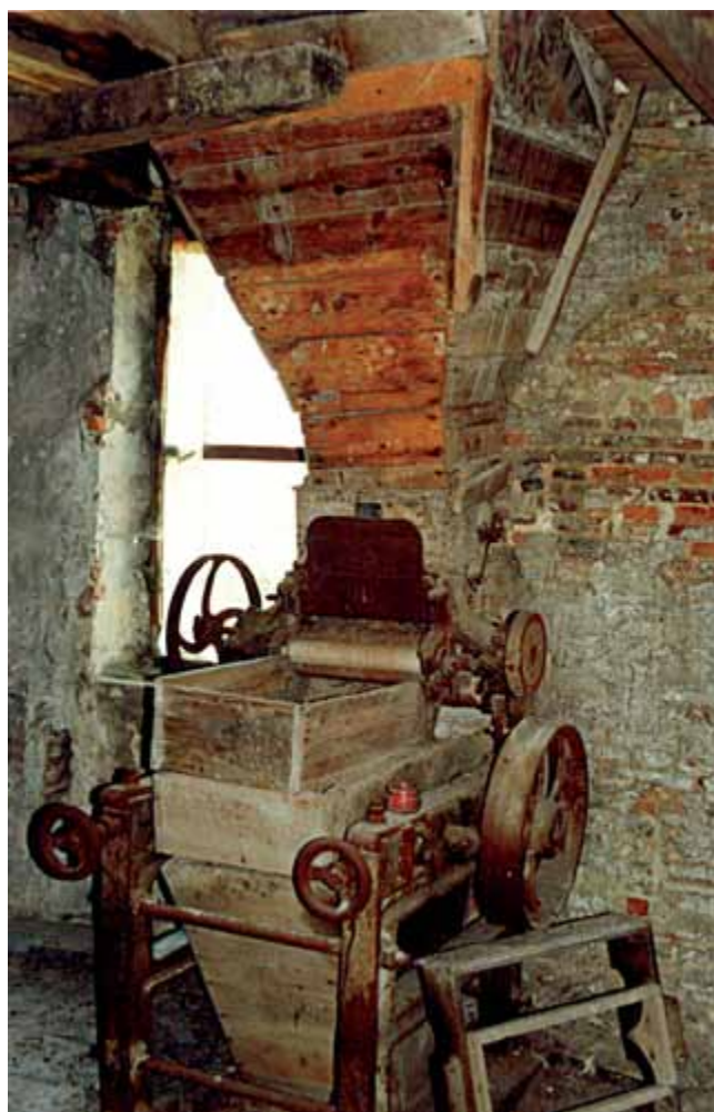
FIG. 135 Wals met porseleinen maalrollen van Wegmann in de 's Hertogenmolens in Aarschot (Collectie E. Goedleven, Bertem). Laminoir avec rouleaux à moudre en porcelaine de Wegmann dans le 's Hertogenmolens à Aarschot.
