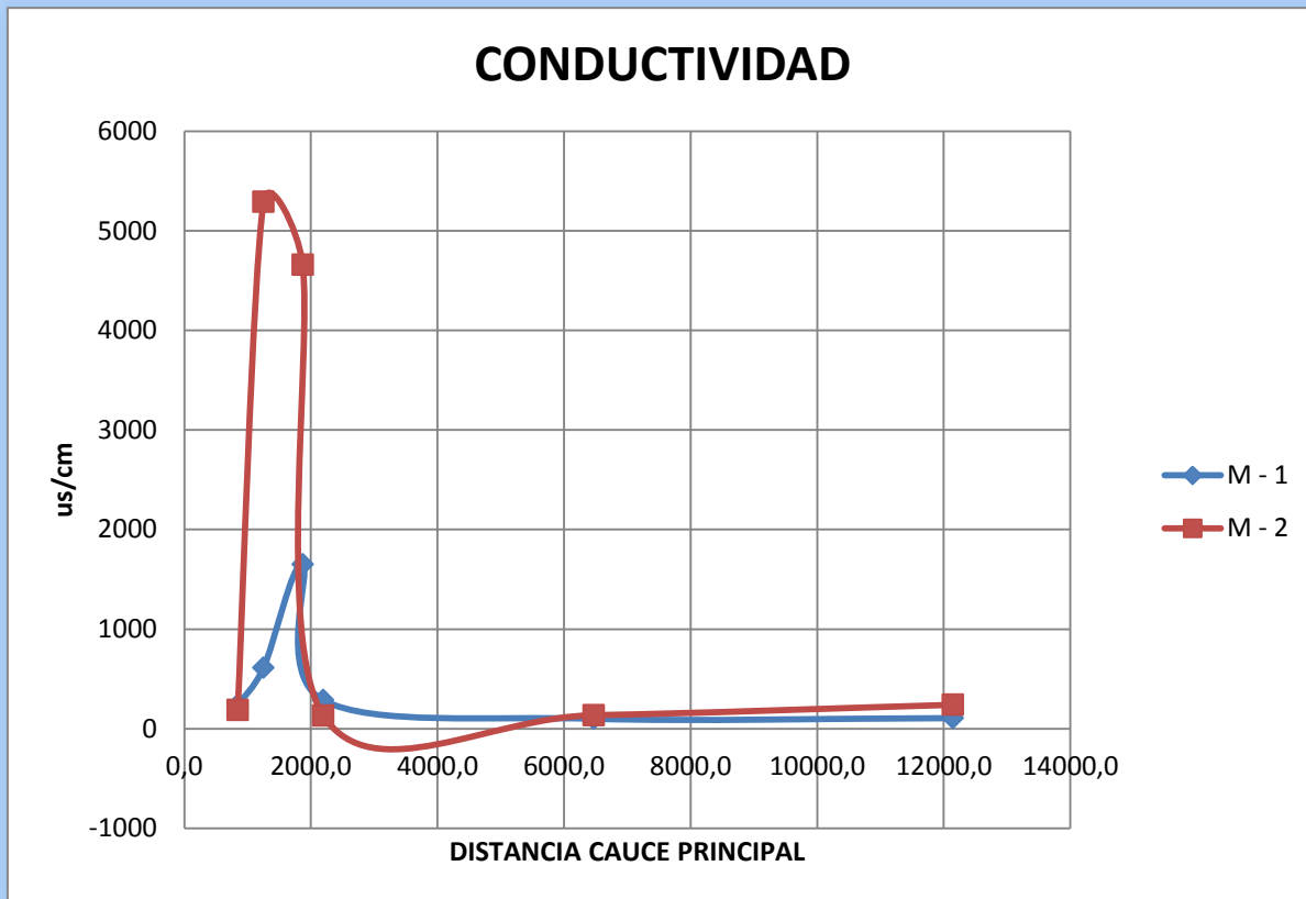
FIGURA 31 COMPORTAMIENTO CONDUCTIVIDAD CAUCE PRINCIPAL
