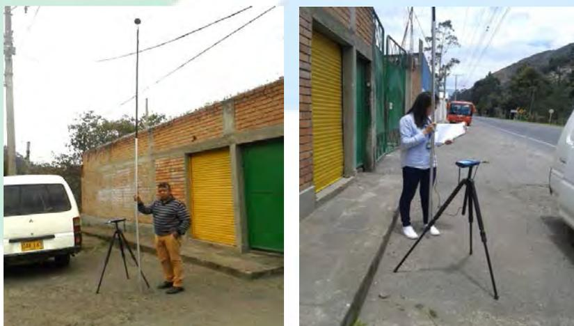
**Foto No 15.** Mediciones sonométricas de ruido ambiental y aforos vehiculares
