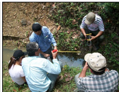
Aforo realizado al canal que conduce el agua al predio Valle del Jaguar para determinar la funcionalidad de la obra de captación.
