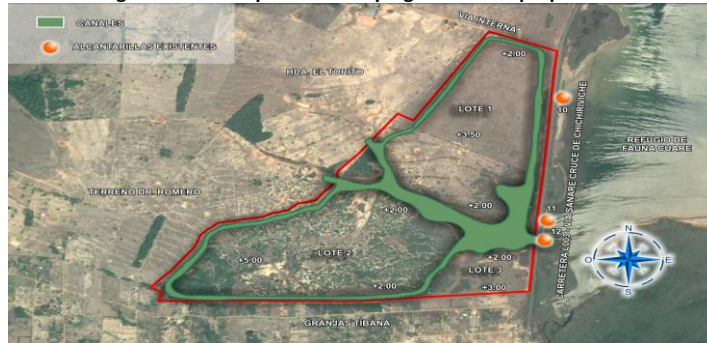
Figura 7. Canales perimetrales y laguna central propuestos.
