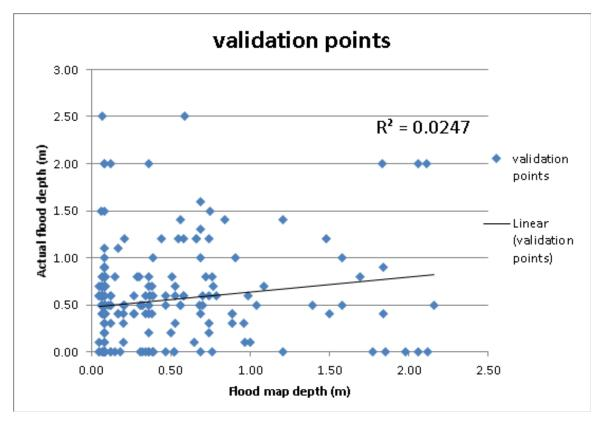
Figure 87. Flood map depth vs. actual flood depth.
