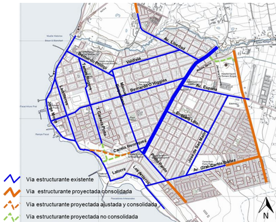
Figura 62 Consolidación de la trama vial propuesta en el PRC vigente, al 2018
