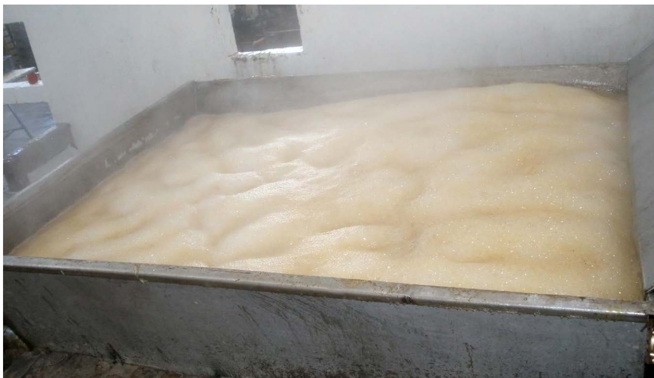
Figura 10.5. Evaporación del agua presente en el jugo de caña de azúcar en el intercambiador de calor o caldero de la hornilla.
