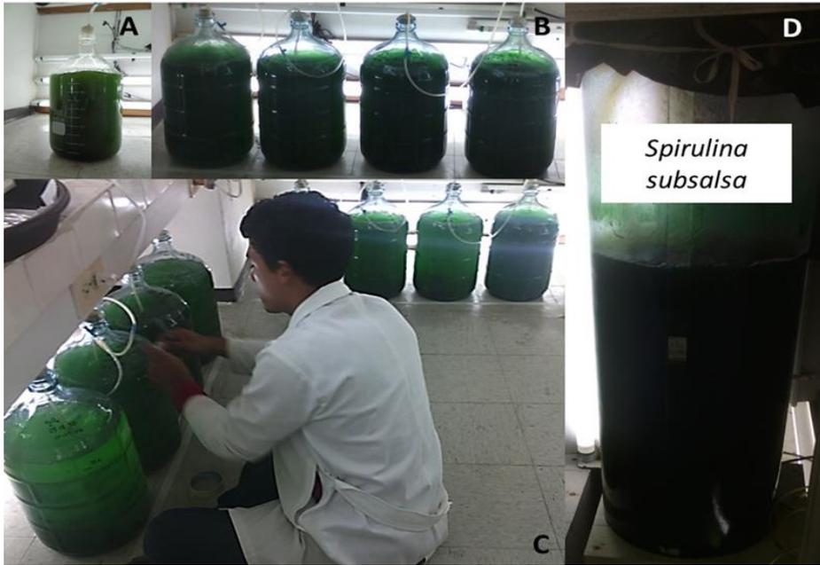
**Figura 3.** Cultivo de *S. subsalsa* a diferentes niveles. A) 5 L, B-C) Garrafón de 17 L y D) Columna cilíndrica de 70 L. Foto: Torres-Ariño, A.
