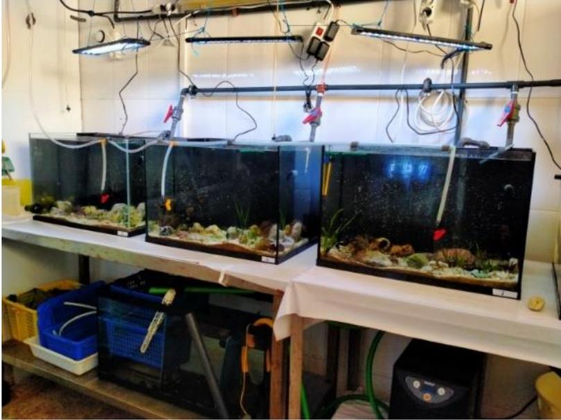
**Figura 2.** Acuarios experimentales en piso superior para *Hippocampus kuda*. En piso inferior sistema de filtración en sump y sistema de termostatación.
