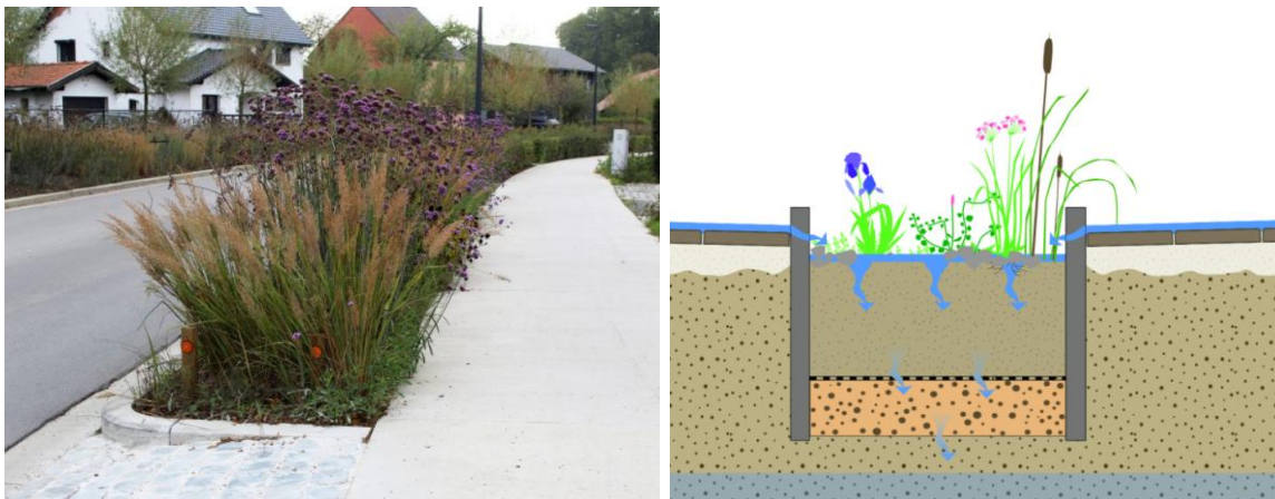
Infiltratiestroken kunnen een oplossing bieden voor waterinfiltratie langs wegen met minder plaats (Bron: blauwgroenvlaanderen.be)
