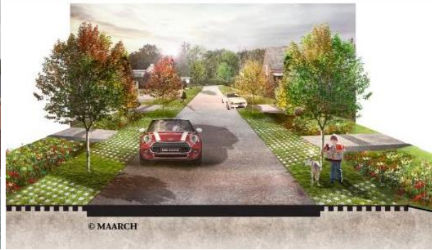
Herinrichting van straten in kader van rioleringswerken: met integratie van groenvoorzieningen, infiltratie en riolering (Bron: blauwgroenvlaanderen.be).
