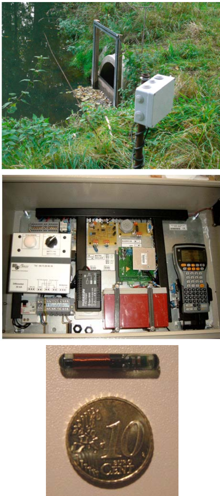
Figure 53. Composants du dispositif CIPAM de détection automatique d'anguilles marquées à la sortie de la nouvelle échelle à poissons de Huccorgne-barrage Collinet. De haut en bas : antenne de détection, boîtier électronique et puce électronique implantée dans le poisson (source : Ovidio et al.,2009).
