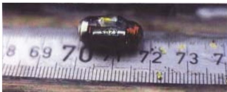
Figure 38. Exemple d'un petit émetteur radio de 1,8 cm-1,8 g utilisé pour le marquage des anguilles dans le Ruisseau des Awirs en 1996.
