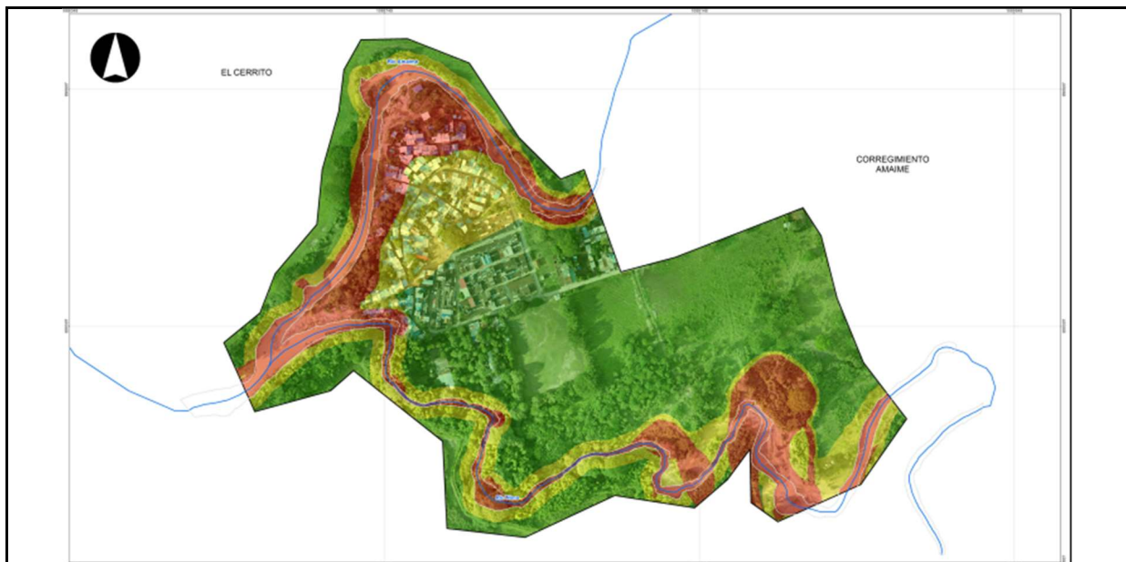
Figura 28. Amenaza por socavación lateral para el sector Barrio Azul - Centro Poblado Amaime. Fuente: (OSSO Estudio 10, 2022)
