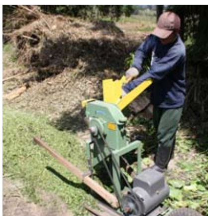
Máquina cortadora de residuos vegetales para generar el compost o el insumo del proceso de gasificación.
