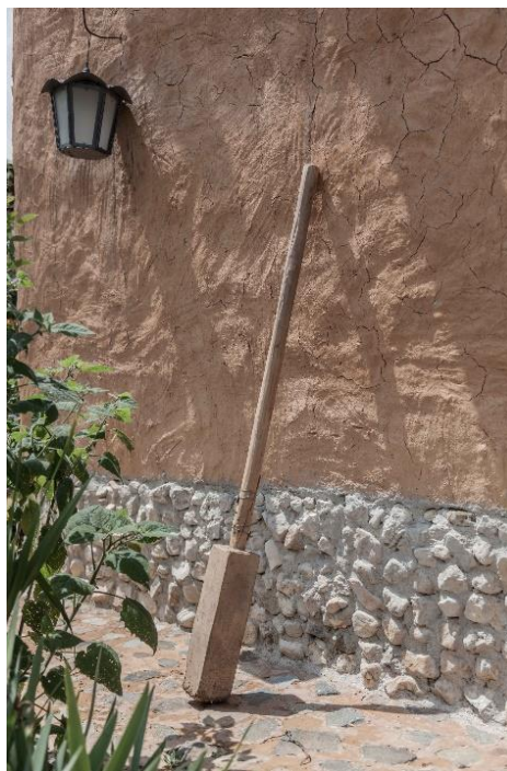
Dos pisones como este servían para compactar la tierra dentro del tapial. Fotografía Jorge Cano. Árbol Visual. 2018.
