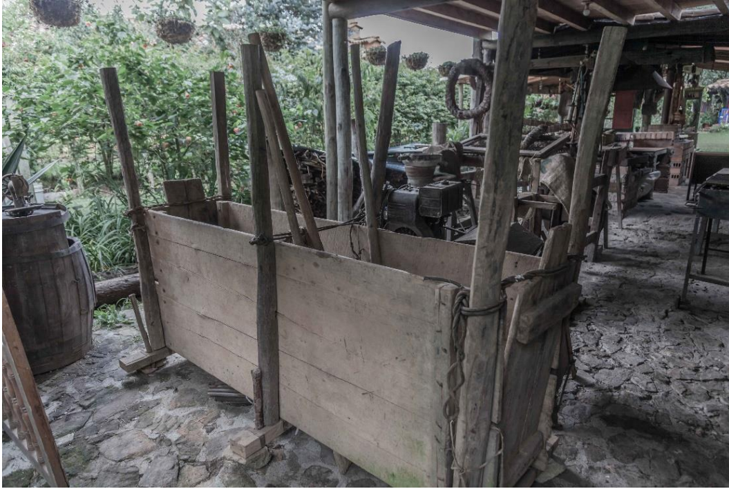
Aspecto de un tapial que se conserva en la finca silletera Abuela Sarito. Fotografía Jorge Cano. Árbol Visual, 2019.
