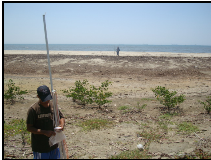
Figura 2. Vista de la toma de datos topográficos de perfiles con dirección perpendicular a la línea de costa.
