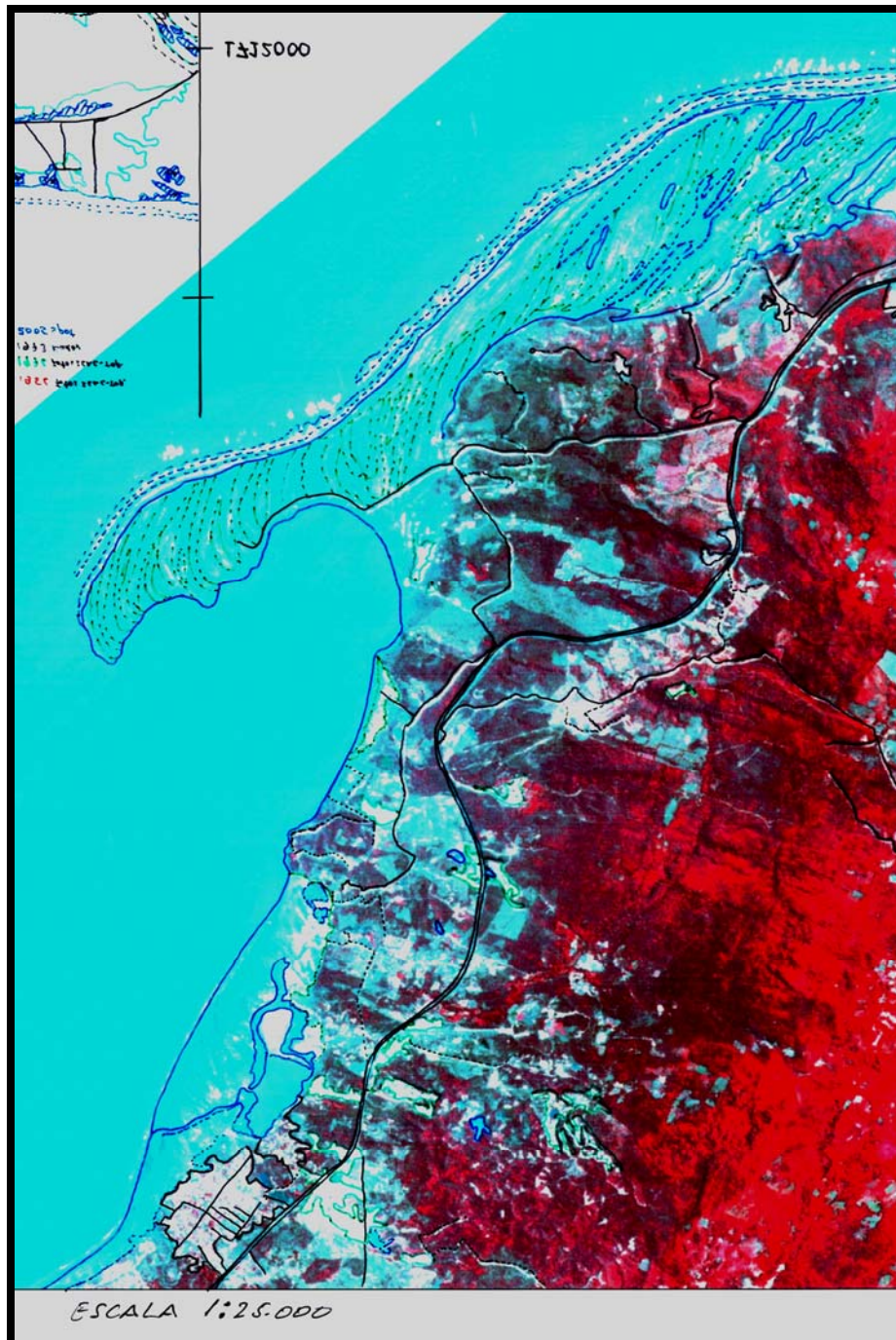
Figura 23. Vista de imagen de satélite georeferenciada a escala 1:25000 del sector Puerto velero – Playa Mendoza. Nótese la progradación de la espiga de Puerto Velero hacia el SW, cuyo avance en la actualidad continúa, siguiendo la tendencia a formar una laguna trasera de consideración. (Tomada de Mendivelso y Pinzón 2010).
