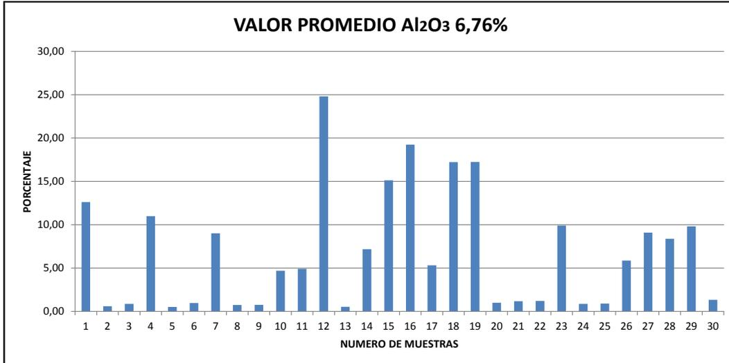
**Figura 47.** Gráfico estadístico (porcentaje vs. muestras) que indica la distribución del contenido de Al<sub>2</sub>O<sub>3</sub> en las muestras analizadas mediante el método FRX.
