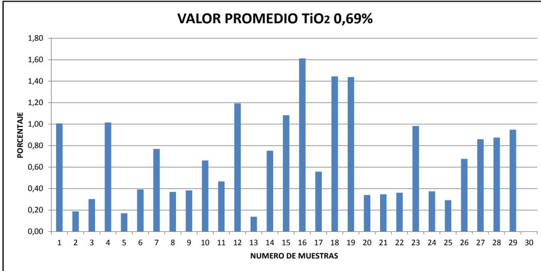
**Figura 45.** Gráfico estadístico (porcentaje vs. muestras) que indica la distribución del contenido de TiO<sub>2</sub> en las muestras analizadas mediante el método FRX.
