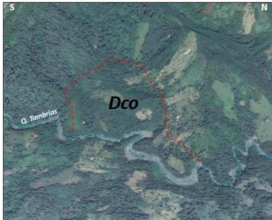
Figura 13. Cono y lóbulo coluvial y de soliflucción (Dco), localizado en el municipio de Otanche, vereda Cambuco
