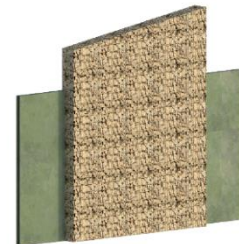
Ilust. 71. Muro en gavión y bahareque. Fuente: elaboración propia
