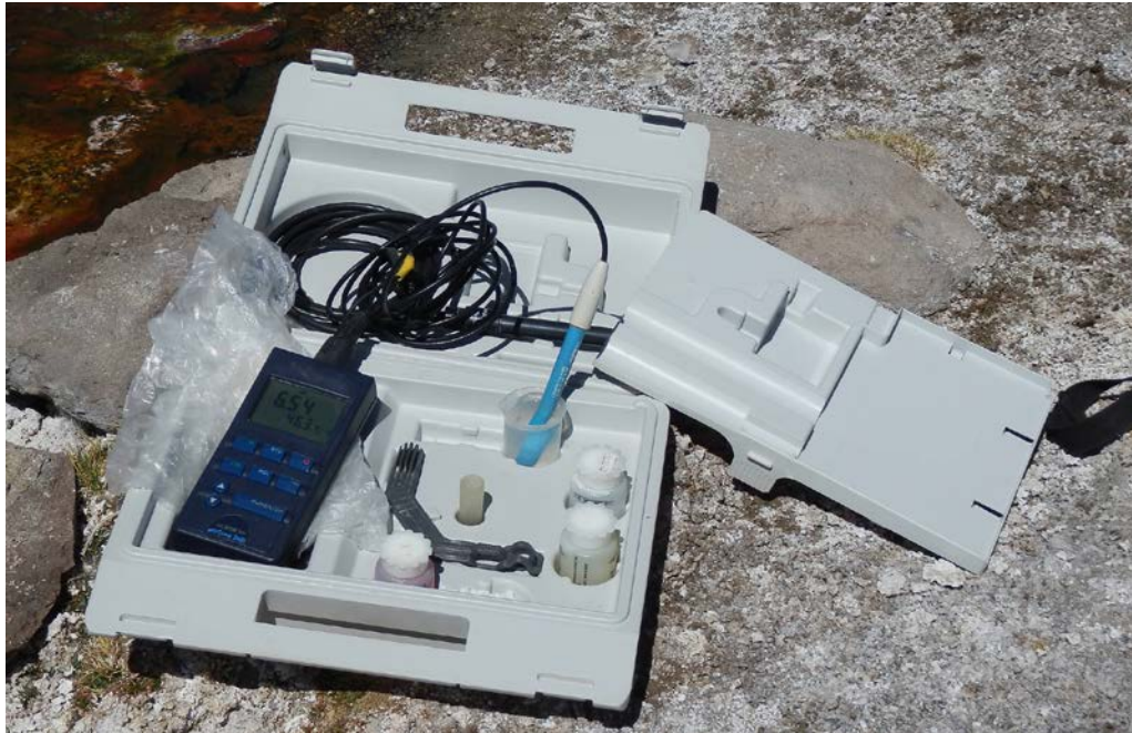
Figura 1.4 Multiparámetro (WTW, modelo 3401) para medición de temperatura, pH, conductividad eléctrica.
