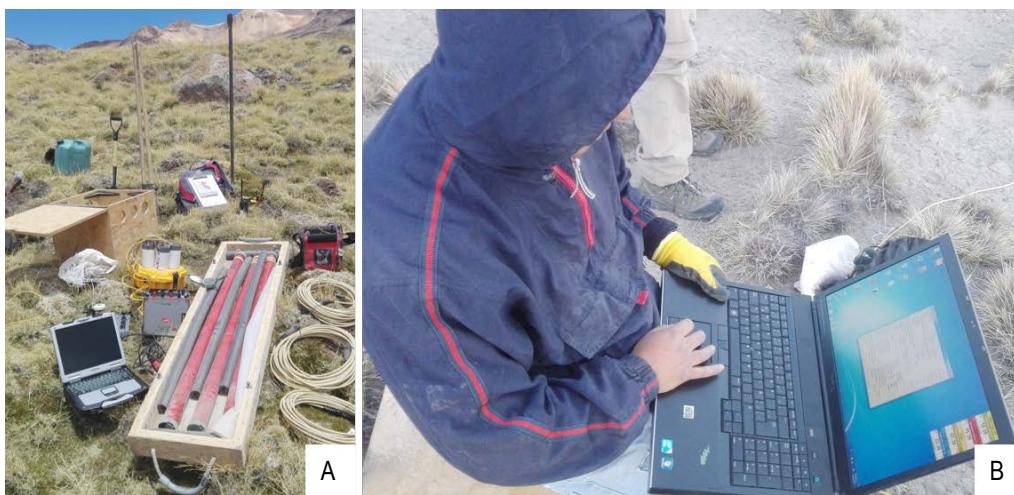
Fotografía 7.1 (A) Instrumentación empleada para la prospección MT. (B) Calibración y configuración de equipos y bobinas en campo.
