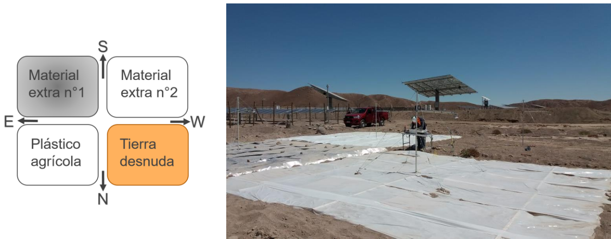
Figura 35. Esquema ubicación de las superficies (izq.) y vista final de la instalación (der.).
