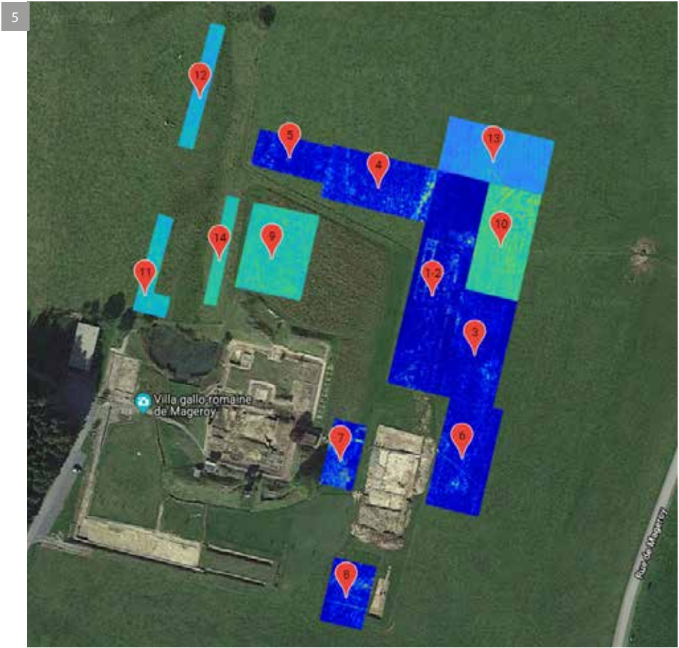
Fig. 5. Image Google Earth situant les différentes zones prospectées par géoradar à Mageroy pendant la période 2015-2017 (© Sébastien Lambot, UCL).
