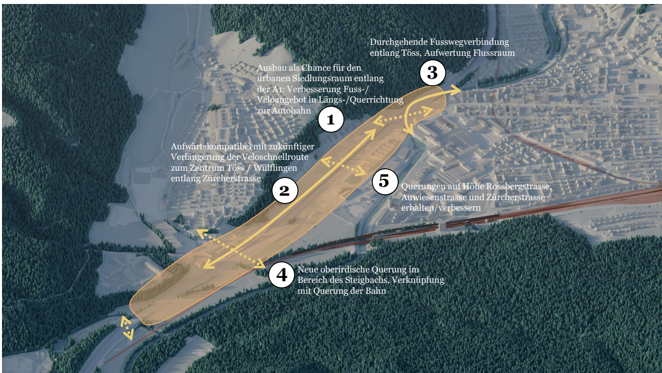
Abbildung 79: Anforderungen Fuss-/Veloverkehr an 6-Spur-Ausbau
