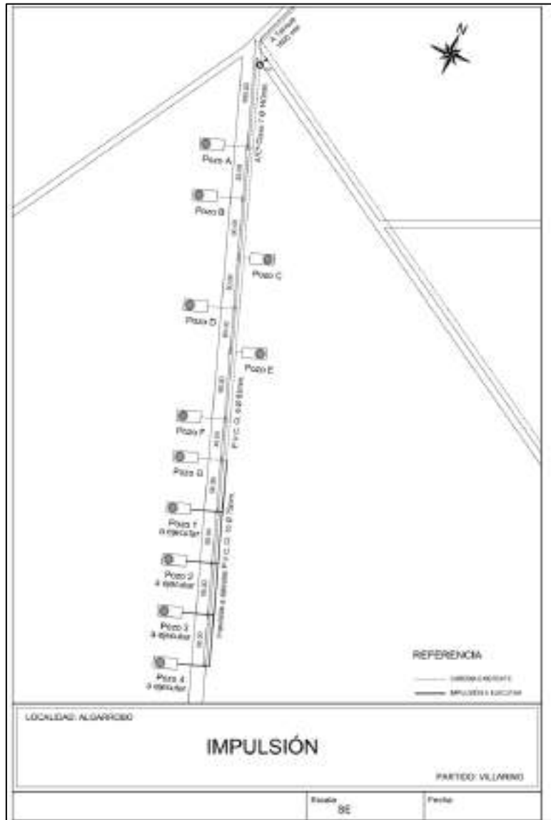
Figura 6: Ubicación de cañería de impulsión y pozos a ejecutar.
