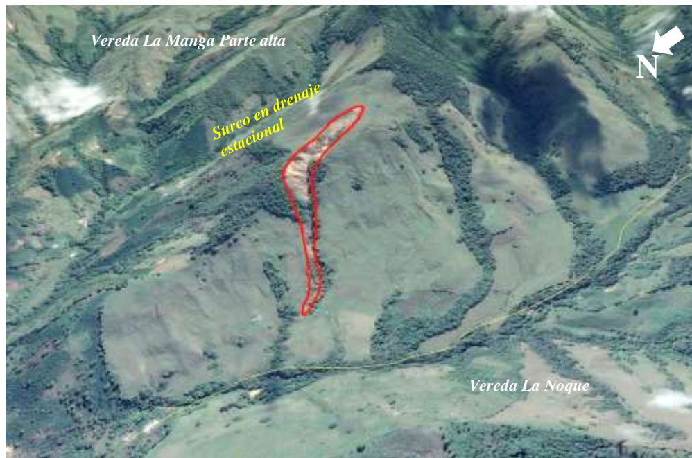
Figura 36. Surco en drenaje estacional
