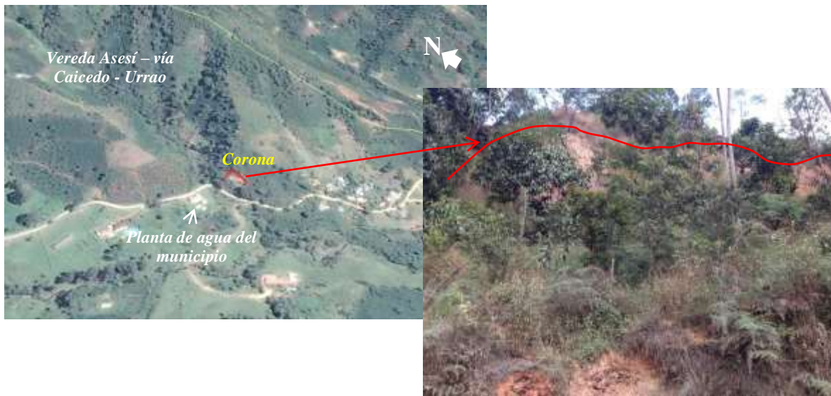
Figura 40. Deslizamiento antiguo e inactivo vía Caicedo – Urrao
