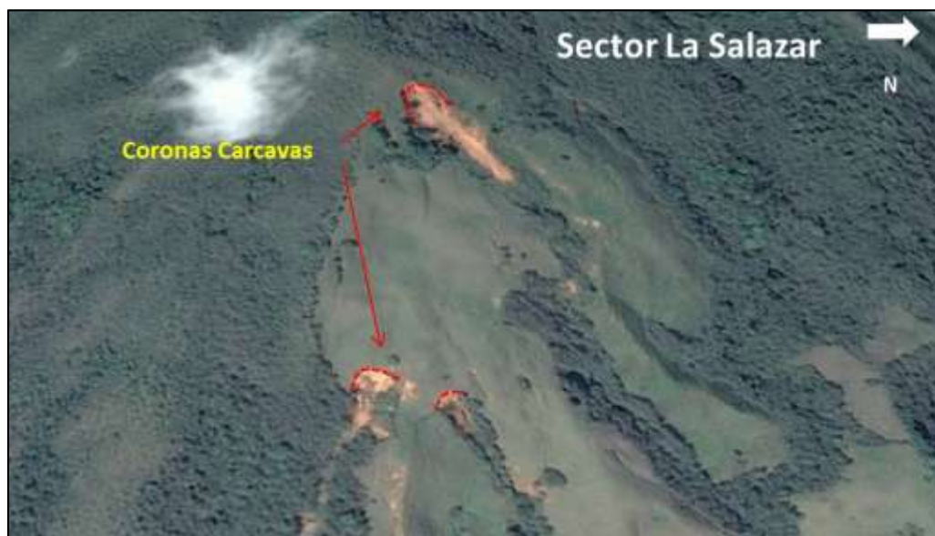
Figura 29. Zona de intensa erosión con carcavamiento retrogresivo, surcos y sobrepastoreo. Vereda La Salazar. Imagen modificada Google Earth 2015.
