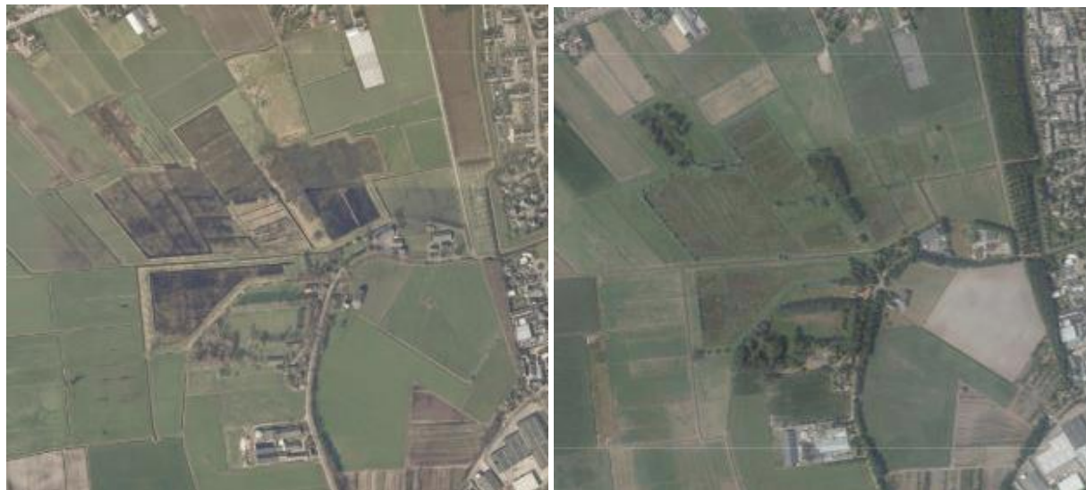
Figuur 3-3: Luchtfoto-beelden van Gastels Laag na de inrichting in 1995. Links luchtfoto 2007, rechts luchtfoto 2019 (Topografische Dienst 2021). Op de luchtfoto uit 2007 staan de afgegraven percelen plas-dras en zijn duidelijk zichtbaar. Rond de percelen ligt een brede berm. Centraal in het gebied zijn de oorspronkelijke reservaatgronden niet afgegraven.
