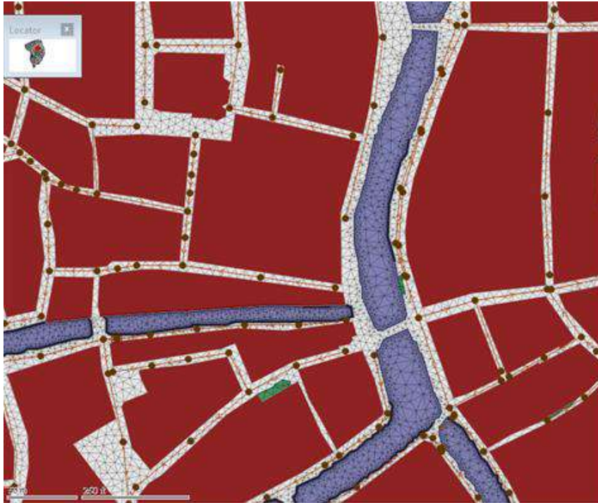
Figuur 17. Aangepast 1D-2D simulatiemodel waarbij een rekenraster voor de oppervlakte werd toegevoegd.
