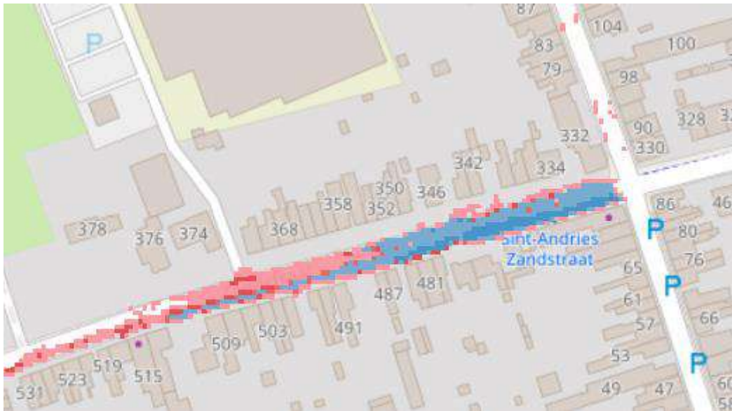
Figuur 25: Pluviale overstromingskaart voor het huidige (blauw) en toekomstig (2100, rood) klimaat ter hoogte van de Zandstraat. Hier werd pluviale wateroverlast waargenomen op 30 augustus 2020.
