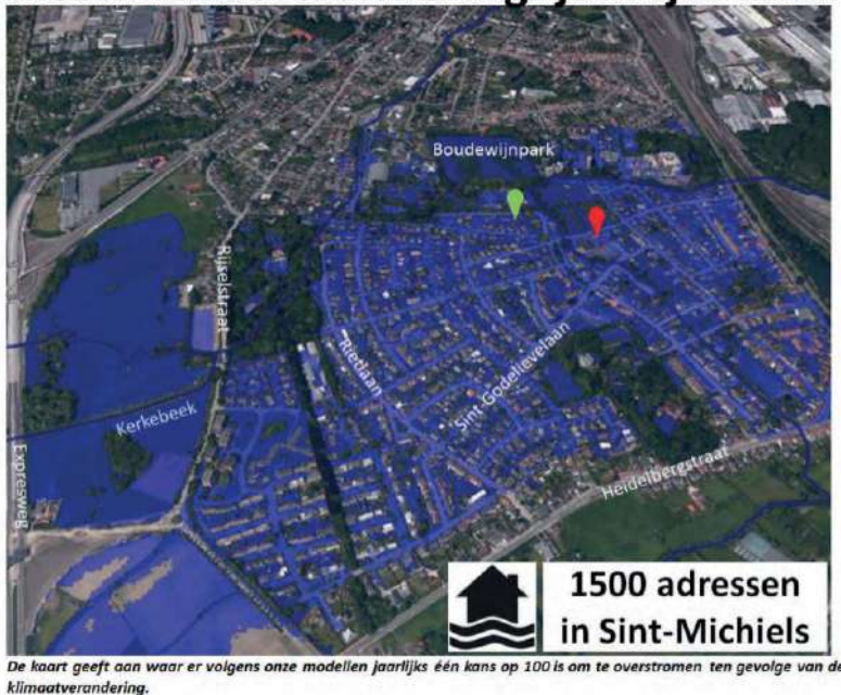
Figuur 33: Overstromingskaarten (T100) voor het huidig en toekomstig (jaar 2100) klimaat voor Sint-Michiels net ten zuiden van het Boudewijnpark (bron: VMM, 2018c).
