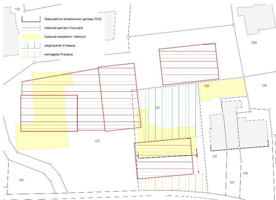
Abbildung 17: Anordnung der Gebäude bestehend (gelb) und der Gebäude gemäss Vorprojekt (rot schraffiert) und Verlagerung des Freiraums zwischen die Überbauung. Plan: i+geo ag, Stand Oktober 2022.
