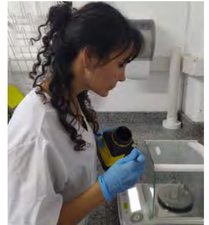
La investigadora determinando la concentración de colorantes naturales en una extracción de la zanahoria.
