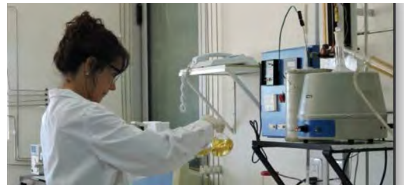
Manuale trabajando con biodiesel para determinar la acidez del mismo.
