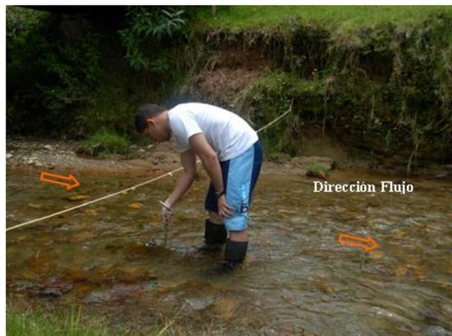
Foto 7. Sección transversal de medición de caudal líquido quebrada Yeguas.
